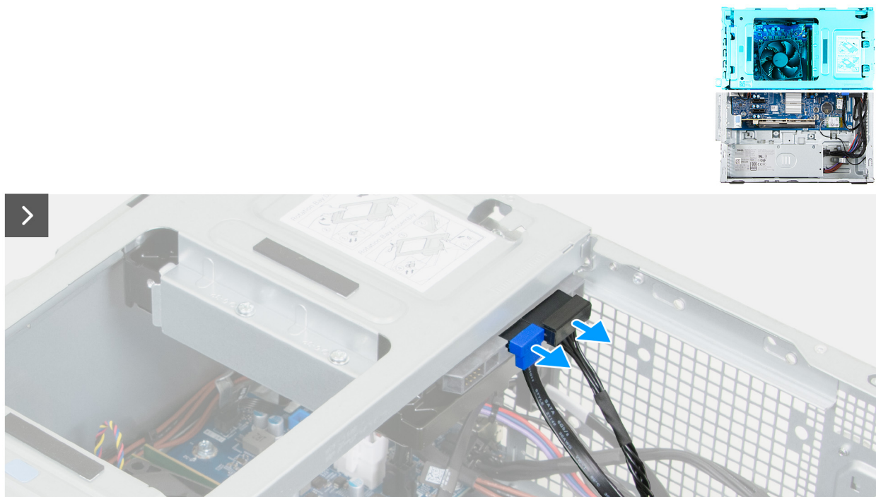
Rysunek 28. Wymontowywanie kieszeni napędu
