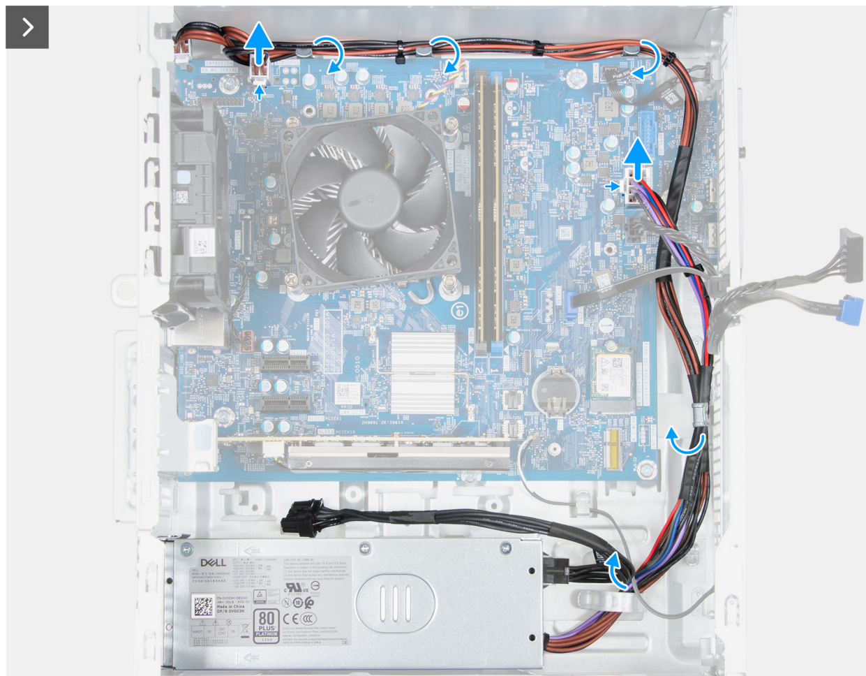
Rysunek 45. Wymontowywanie zasilacza
