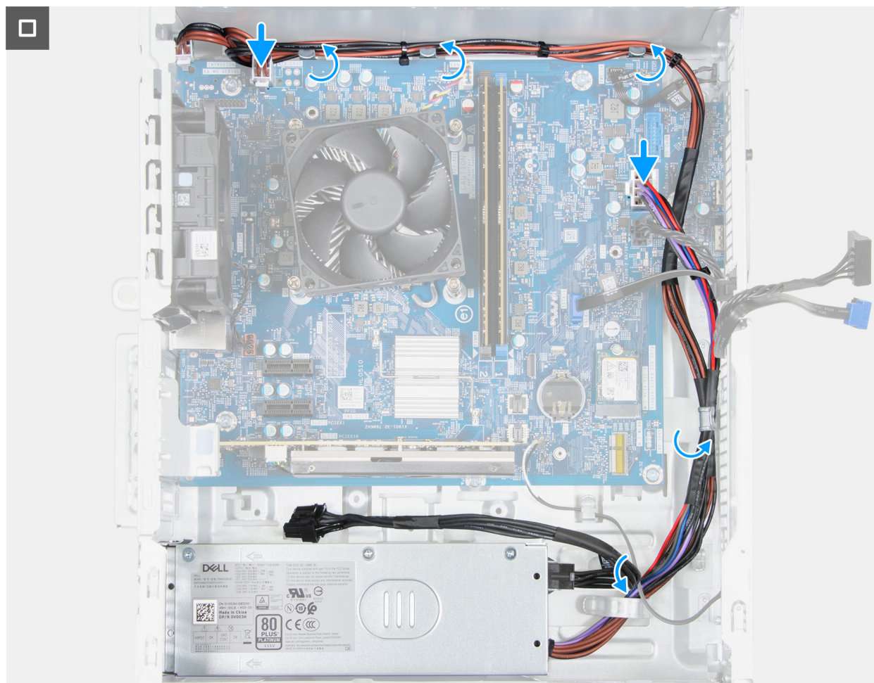
Rysunek 48. Instalowanie zasilacza
