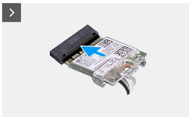
Rysunek 27. Instalowanie karty sieci bezprzewodowej
