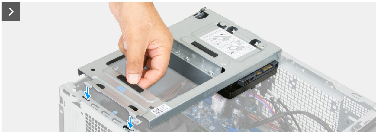
איור 30. התקנת מפרץ הכונן
