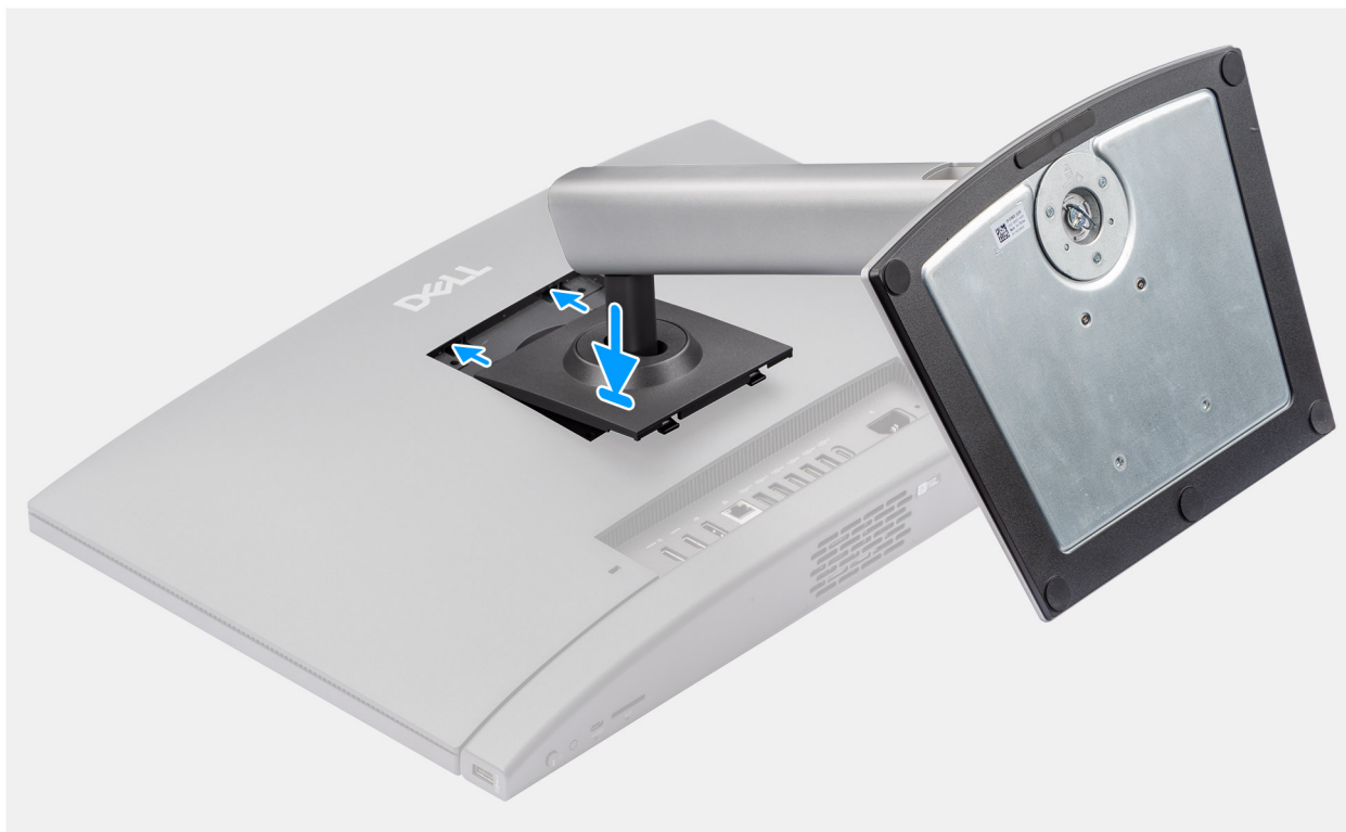
Rysunek 15. Instalowanie podstawy o regulowanej wysokości
