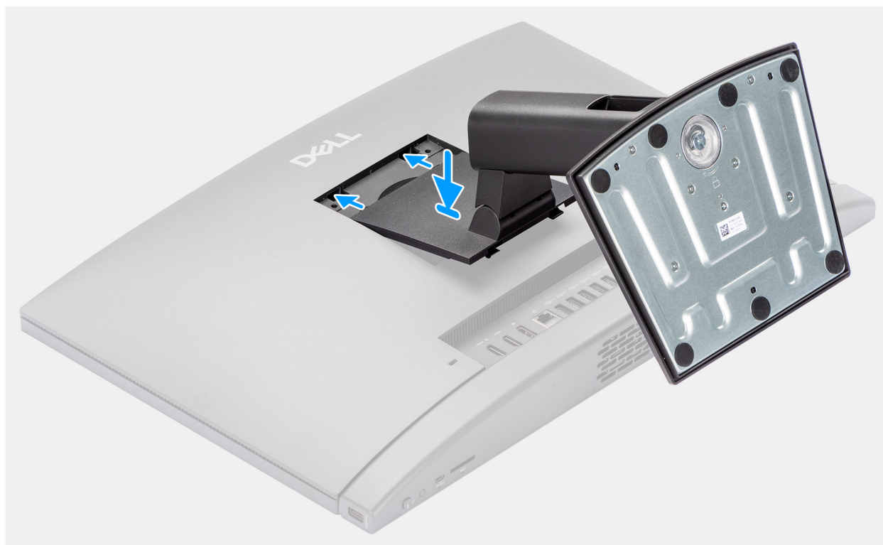
Rysunek 16. Instalowanie podstawy stałej
