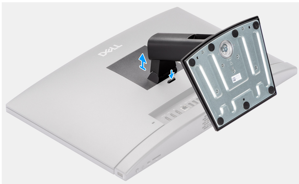
Rysunek 14. Wymontowywanie podstawy stałej
