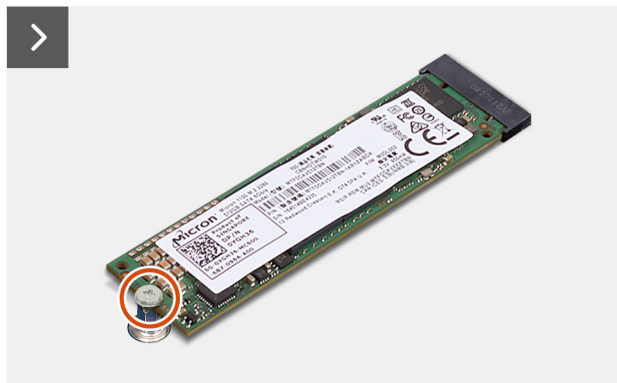
Rysunek 38. Wymontowywanie dysku SSD M.2 2280 z gniazda M.2 nr 1
