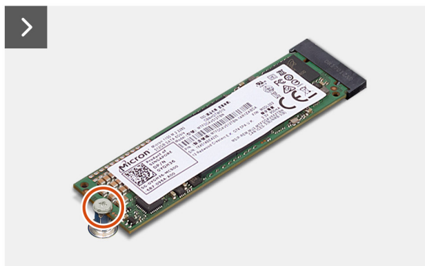
Rysunek 33. Wymontowywanie dysku SSD M.2 2280 z gniazda M.2 nr 0
