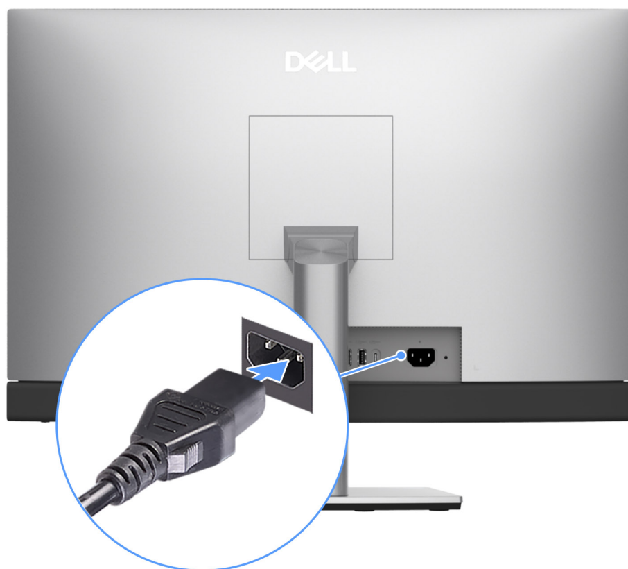
Rysunek 12. Podłączanie kabla zasilającego
