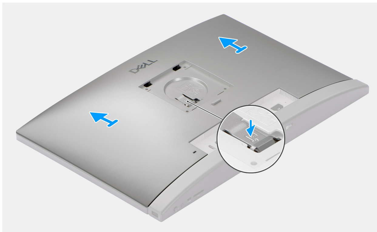
Rysunek 19. Wymontowywanie pokrywy tylnej
