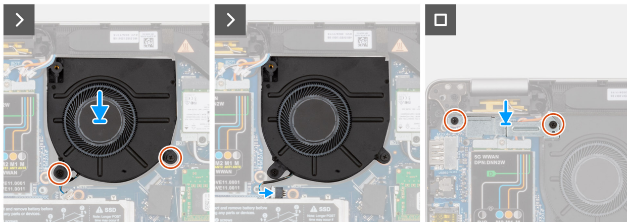
Rysunek 40. Instalowanie wentylatora
