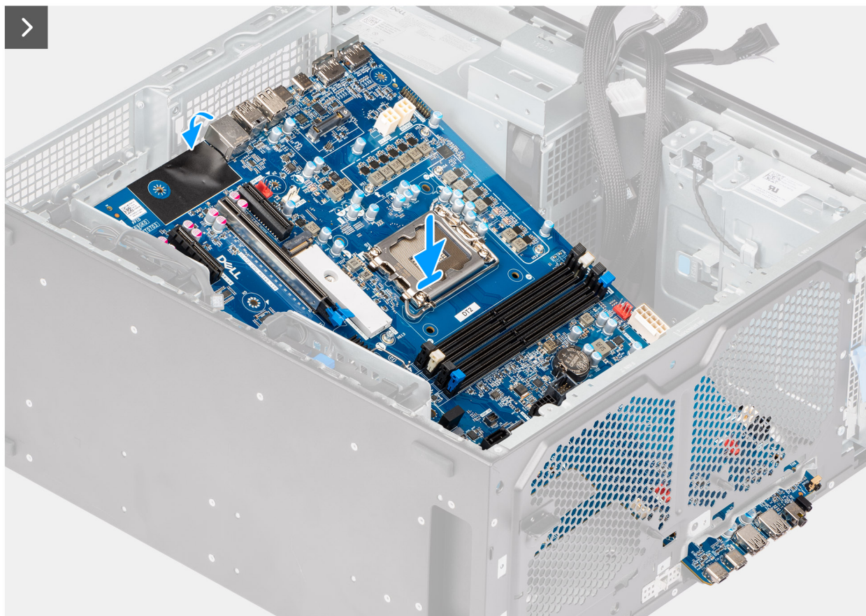
Rysunek 94. Instalowanie płyty głównej
