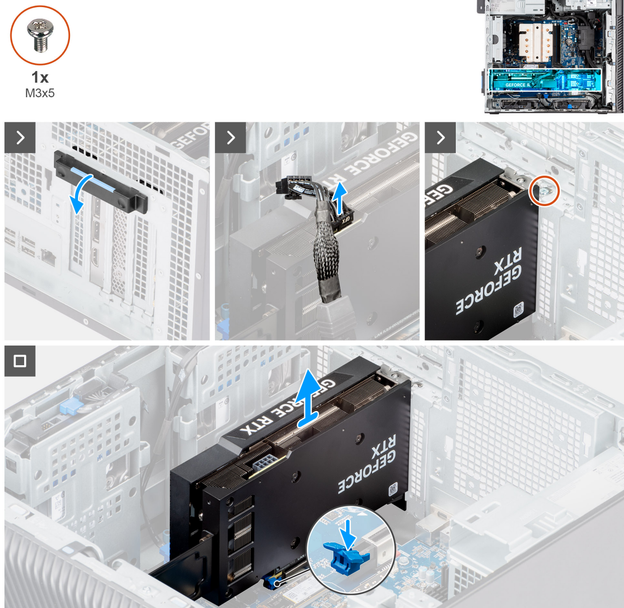
Rysunek 39. Wymontowywanie zasilanej karty graficznej
