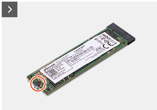
Rysunek 33. Wymontowywanie dysku SSD PCIe M.2 2280
