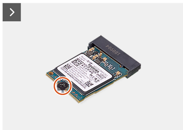
Rysunek 31. Wymontowywanie dysku SSD PCIe M.2 2230
