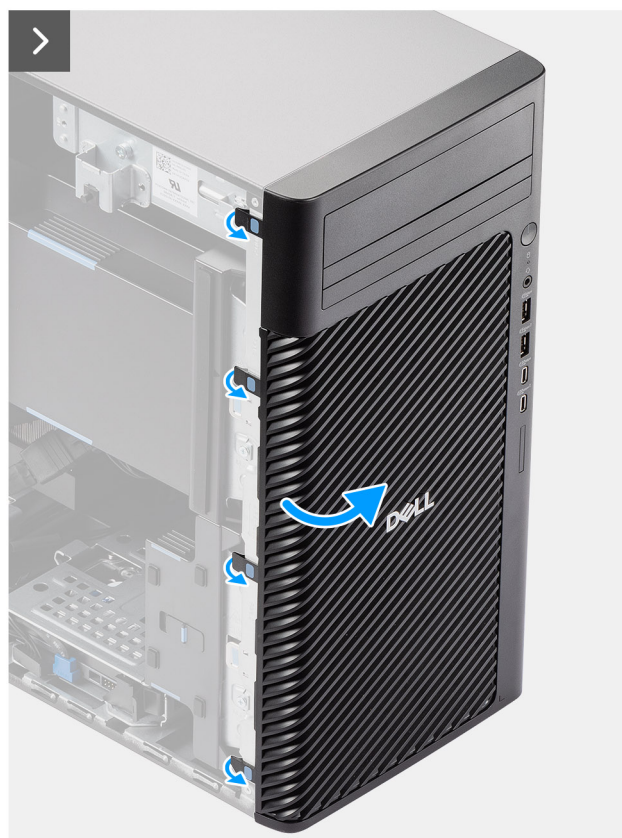
Rysunek 17. Wymontowywanie ramki przedniej
