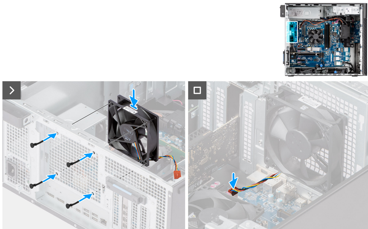
Rysunek 50. Instalacja tylnego wentylatora do komputerów z zasilaczem 360 W
