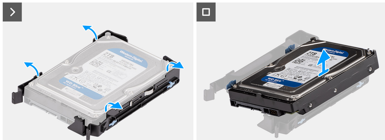
Rysunek 27. Wymontowywanie klamry dysku twardego 3,5”
