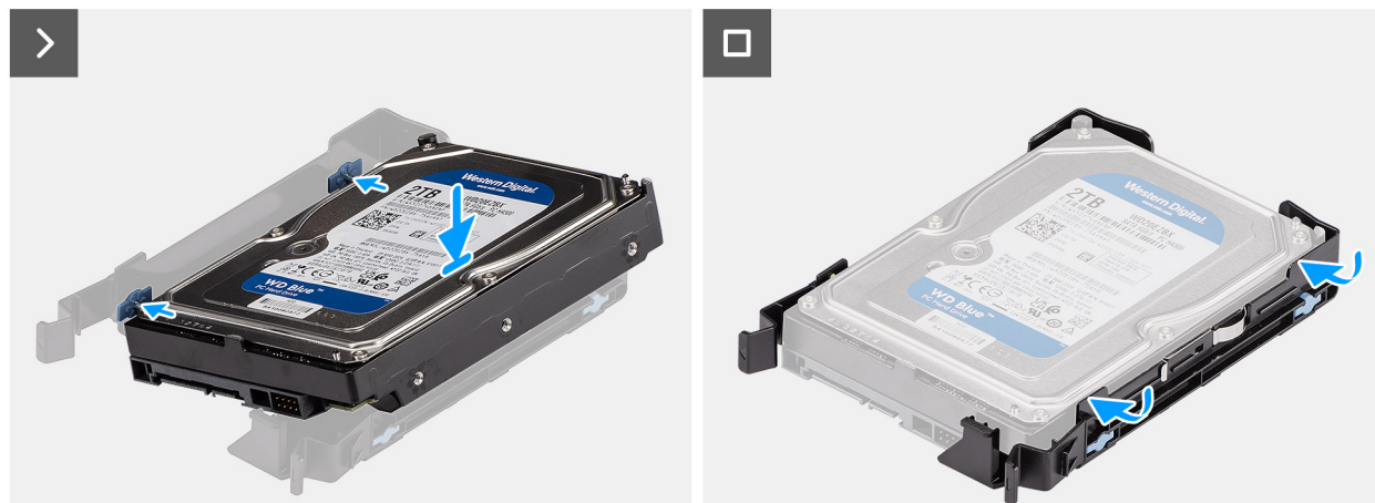
Rysunek 28. Instalowanie klamry dysku twardego 3,5"
