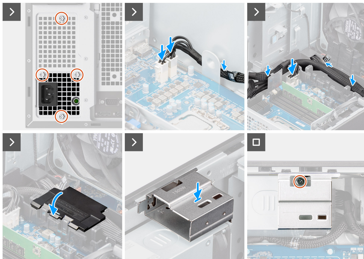
Rysunek 56. Instalowanie zasilacza 1500 W
