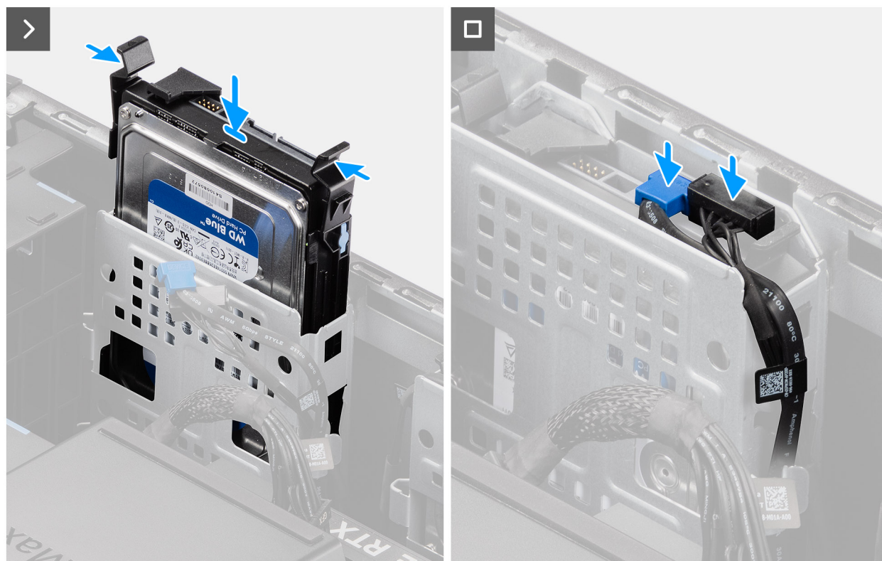
Rysunek 30. Instalowanie zestawu dysku twardego 3,5" z kieszeni 1
