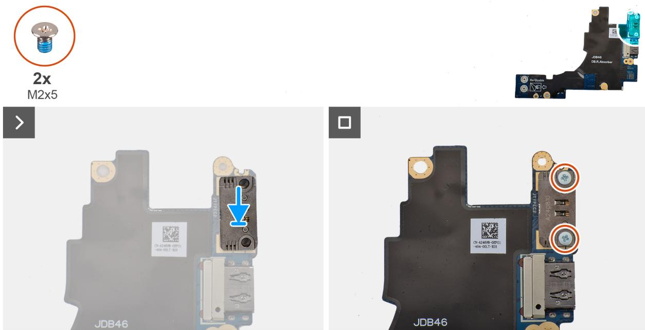
**Abbildung 51. Installieren des linken USB Typ-C-Moduls**
