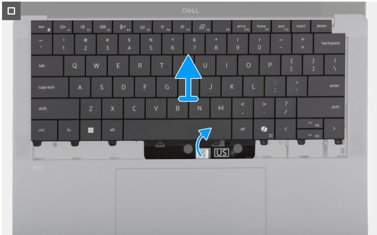
**Abbildung 72. Entfernen der Tastaturbaugruppe**
