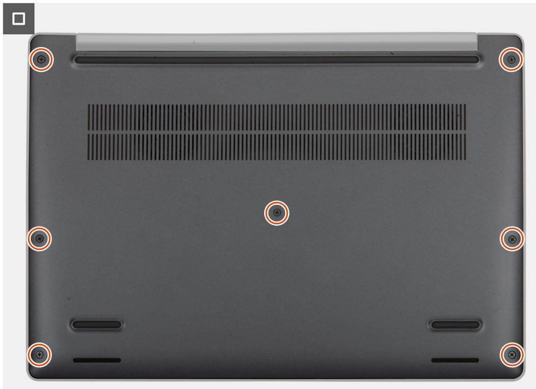
Abbildung 19. Festziehen der unverlierbaren Schrauben
