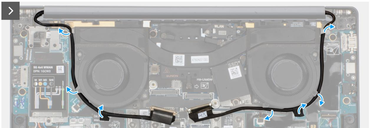
Abbildung 56. Trennen der Display- und Kamerakabel
