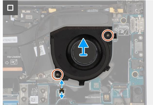
Abbildung 28. Entfernen des linken Lüfters
