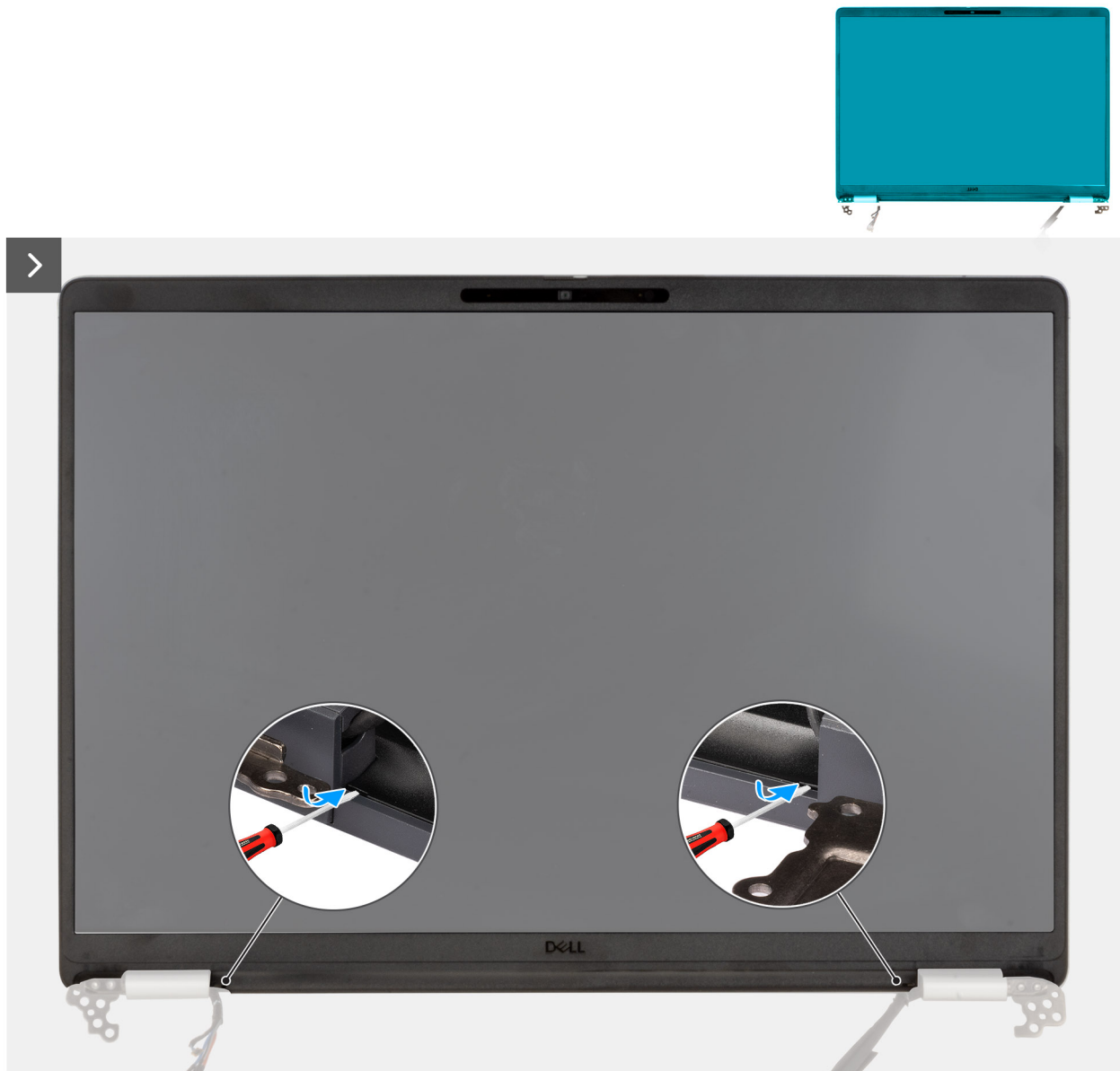
Afbeelding 59. De plastic bezel loswrikken
