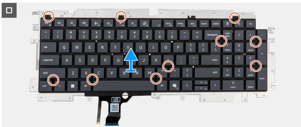
Afbeelding 80. Het toetsenbord verwijderen
