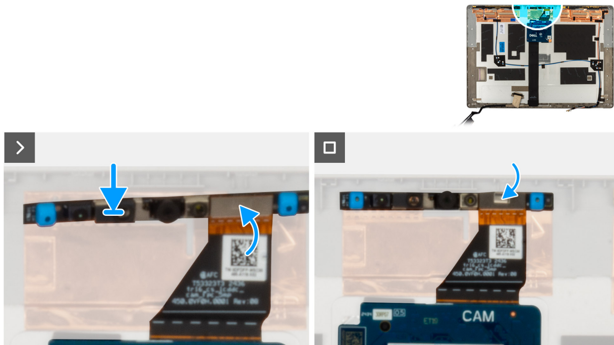
Afbeelding 74. De cameramodule installeren
