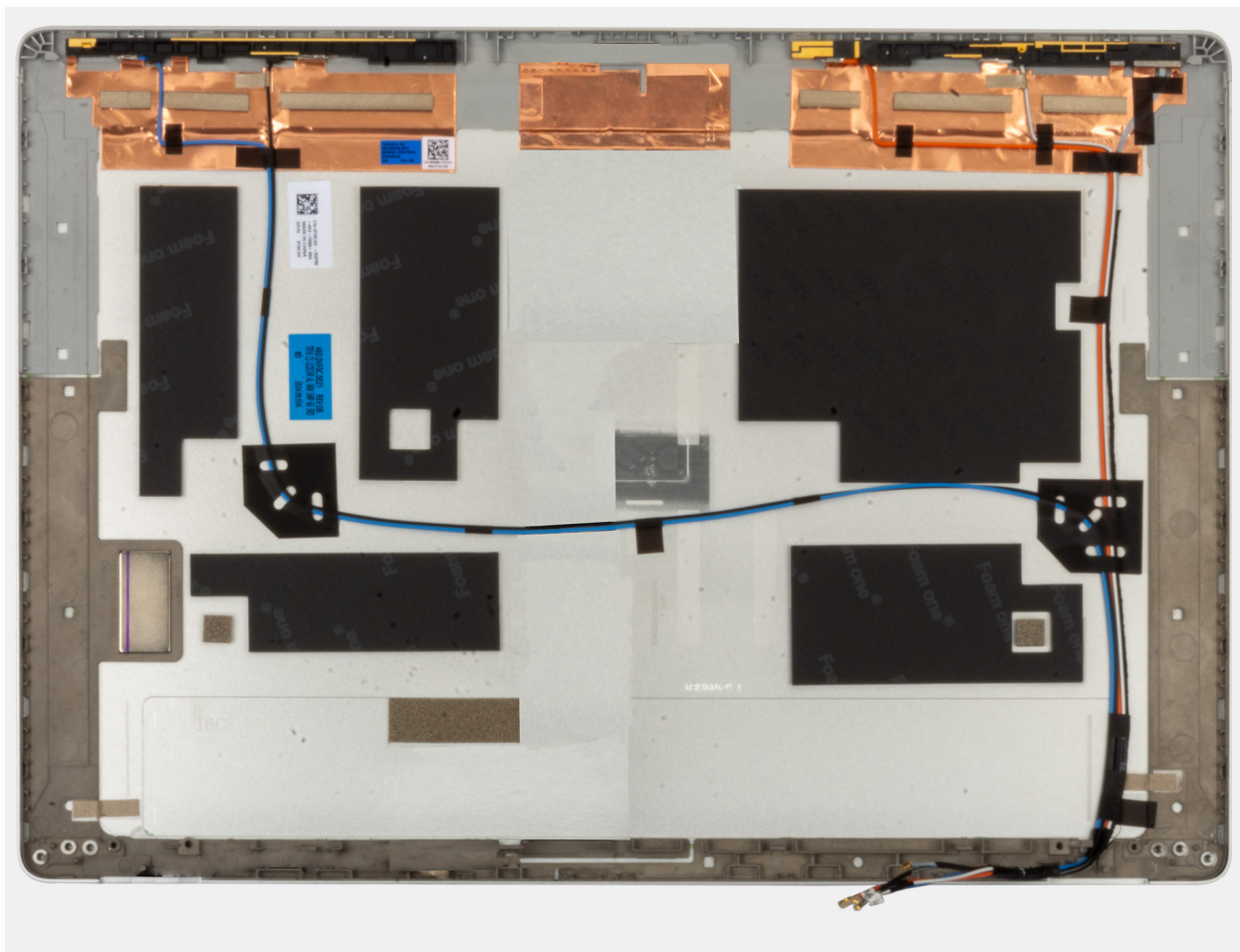
Afbeelding 76. Het achterpaneel van het beeldscherm installeren
