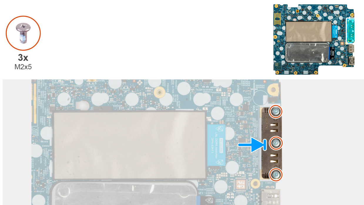
Afbeelding 78. De USB Type-C-connectormodule installeren
