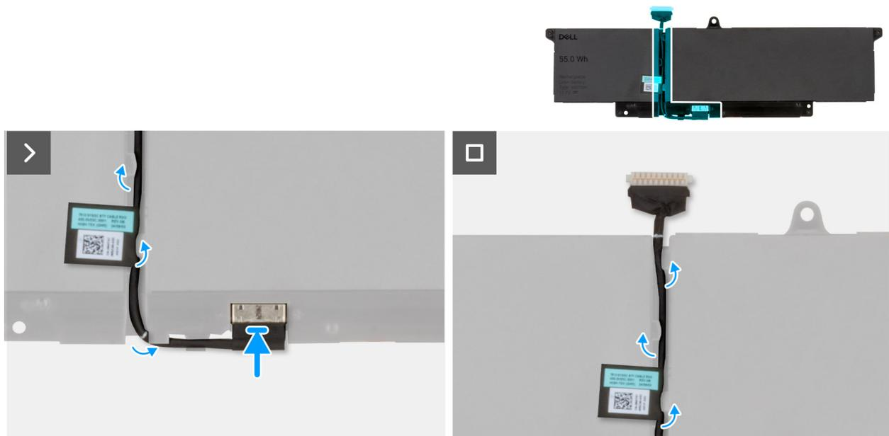
Figure 19. Installation du câble de la batterie
