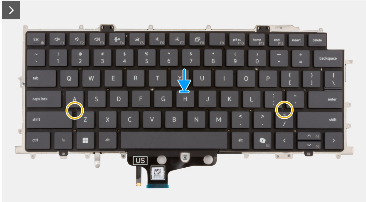
Afbeelding 99. Het toetsenbord installeren
