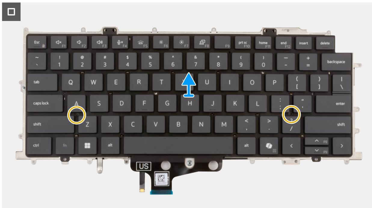
Afbeelding 98. Het toetsenbord verwijderen
