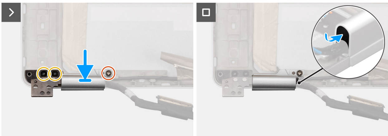
Afbeelding 86. De beeldschermkabel installeren
