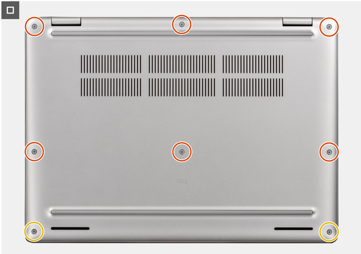
Afbeelding 26. De onderplaat installeren
