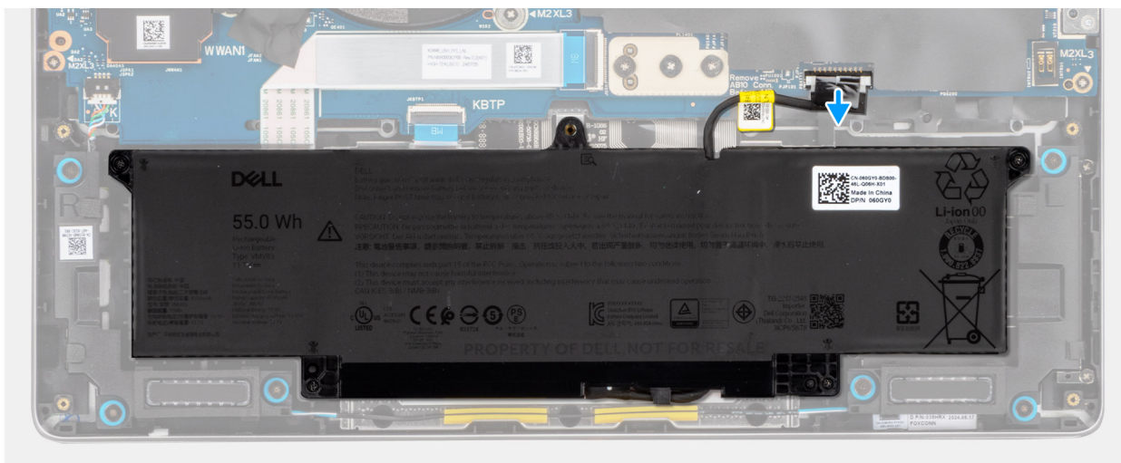
Afbeelding 24. De batterijkabel loskoppelen
