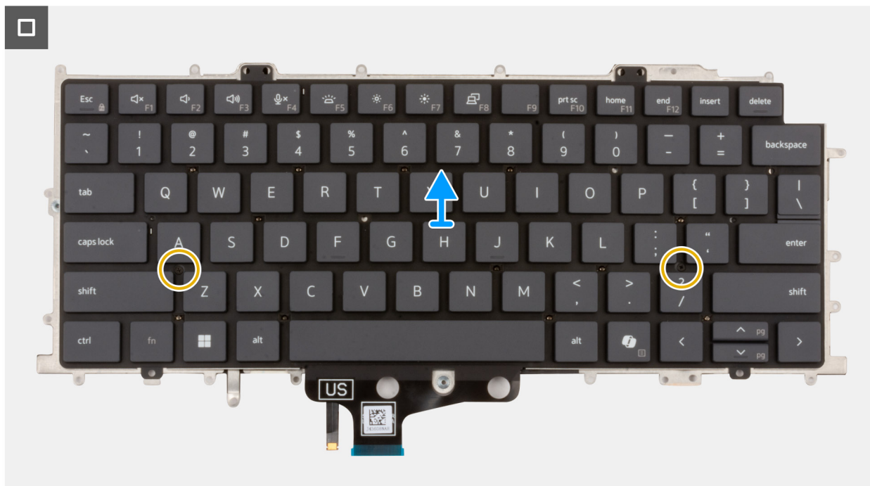
Figure 98. Retrait du clavier
