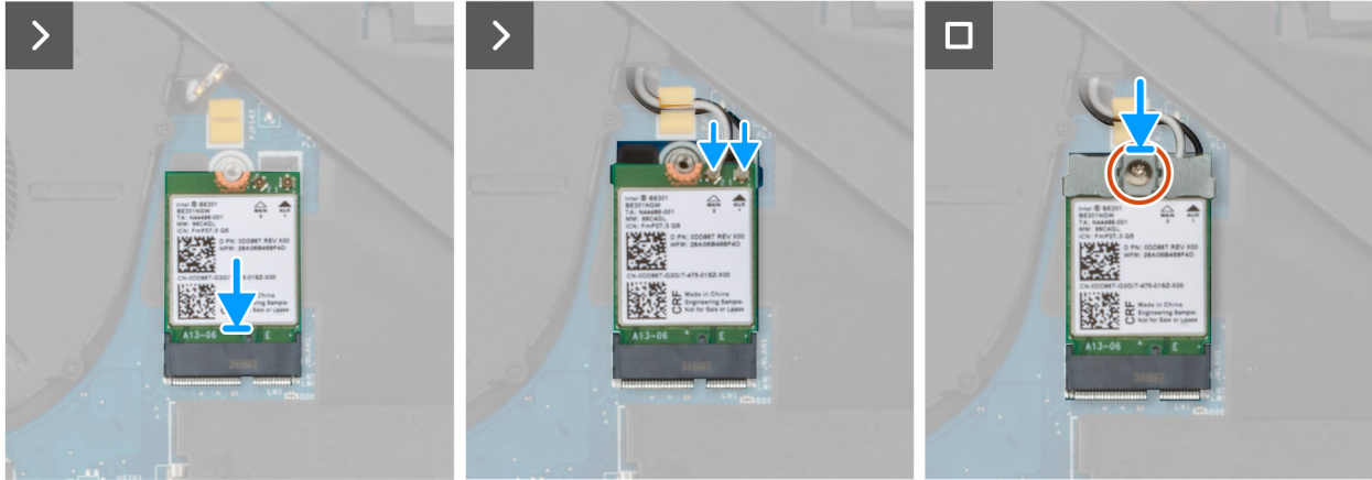
Figure 40. Installation de la carte WLAN
