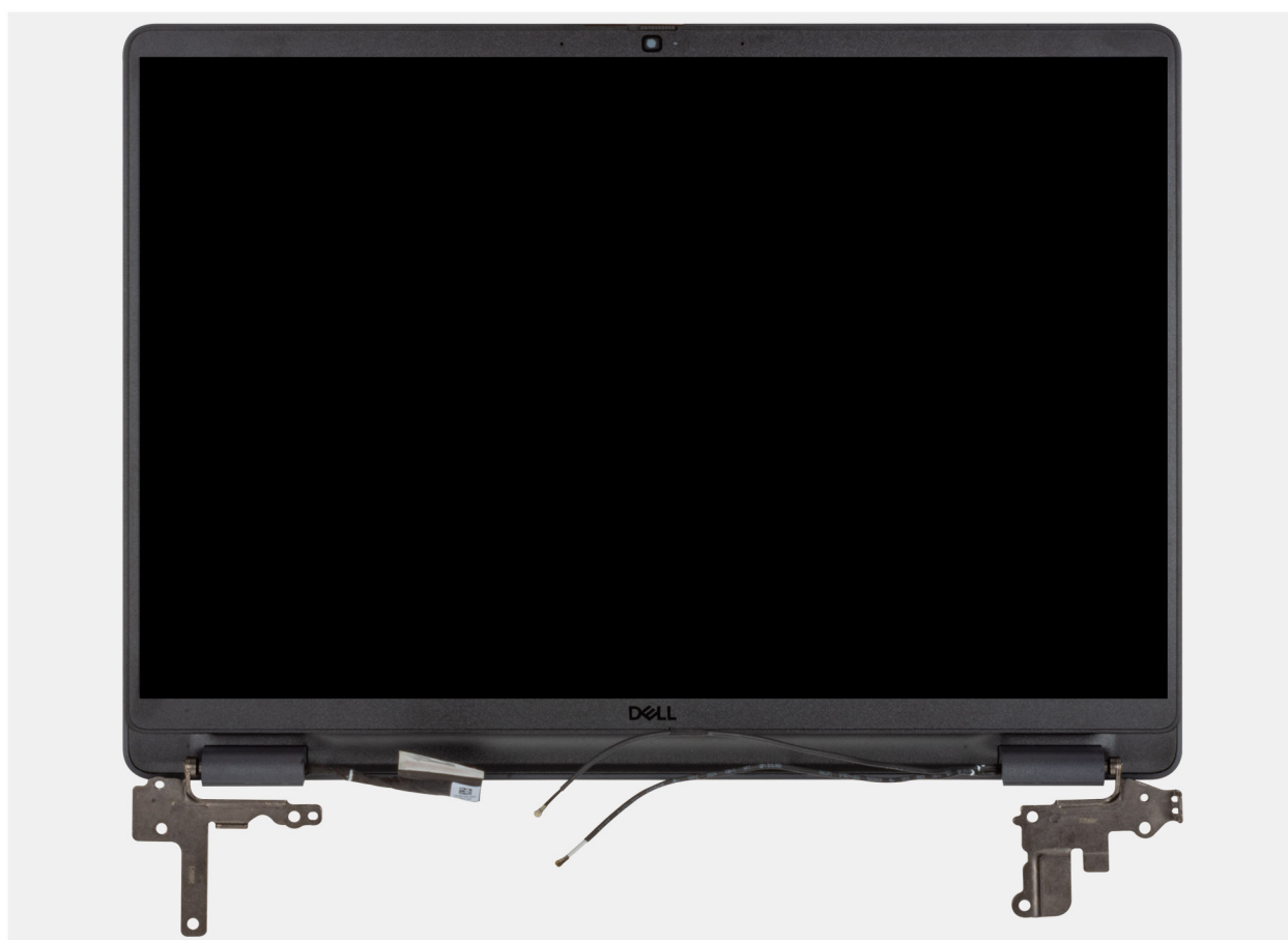
Figura 74. Rimozione del gruppo del display
