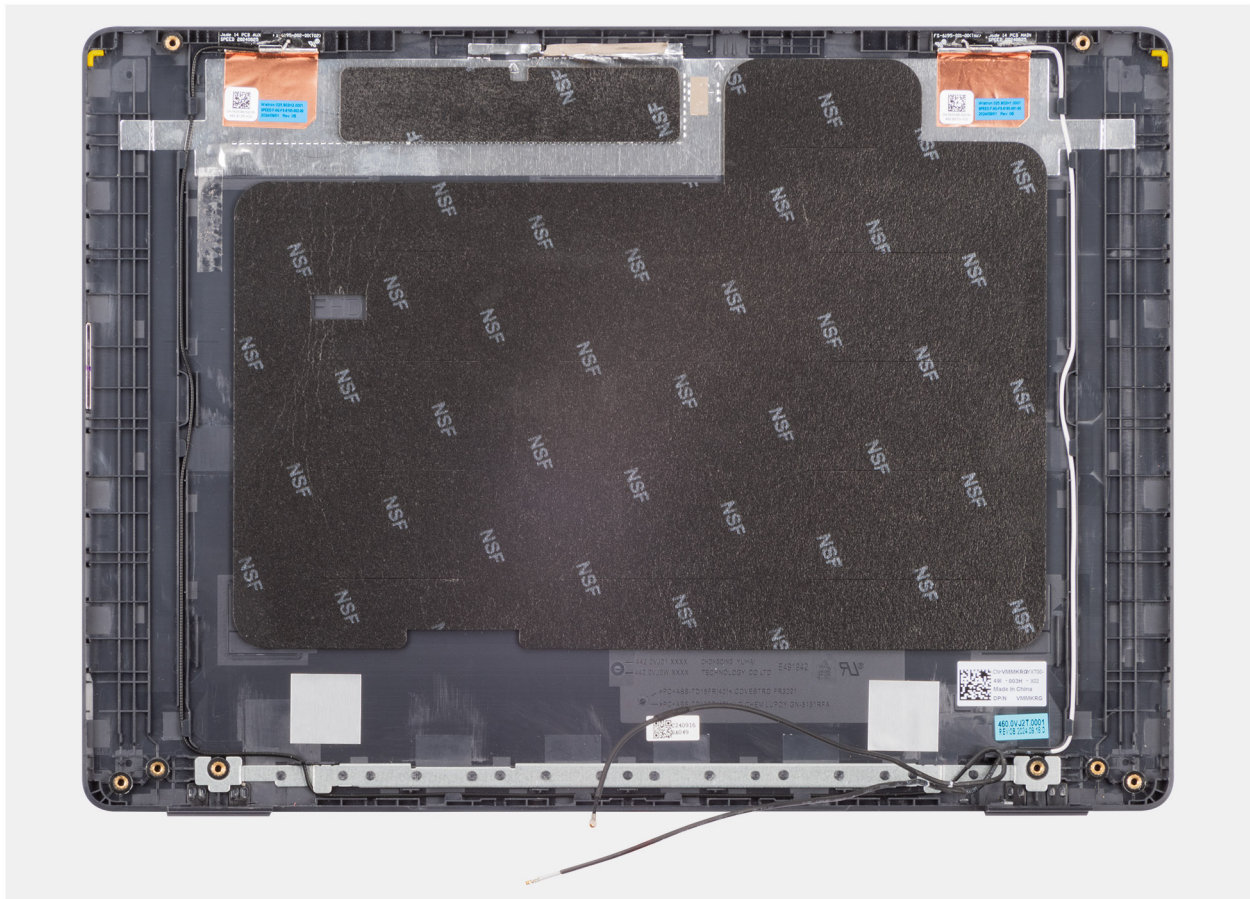
Figura 96. Rimozione del gruppo coperchio posteriore del display
