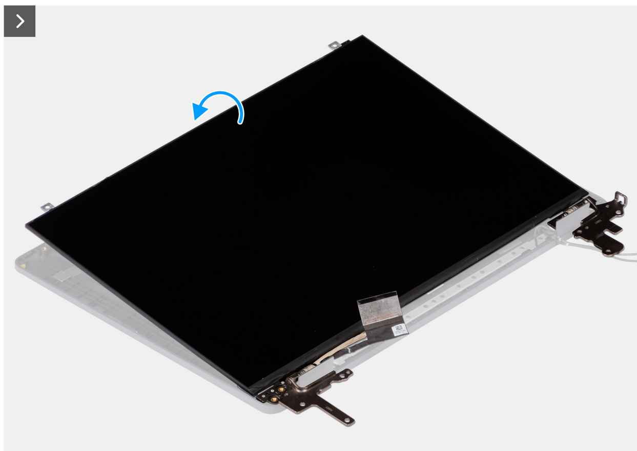
Figura 90. Installazione del gruppo del pannello del display
