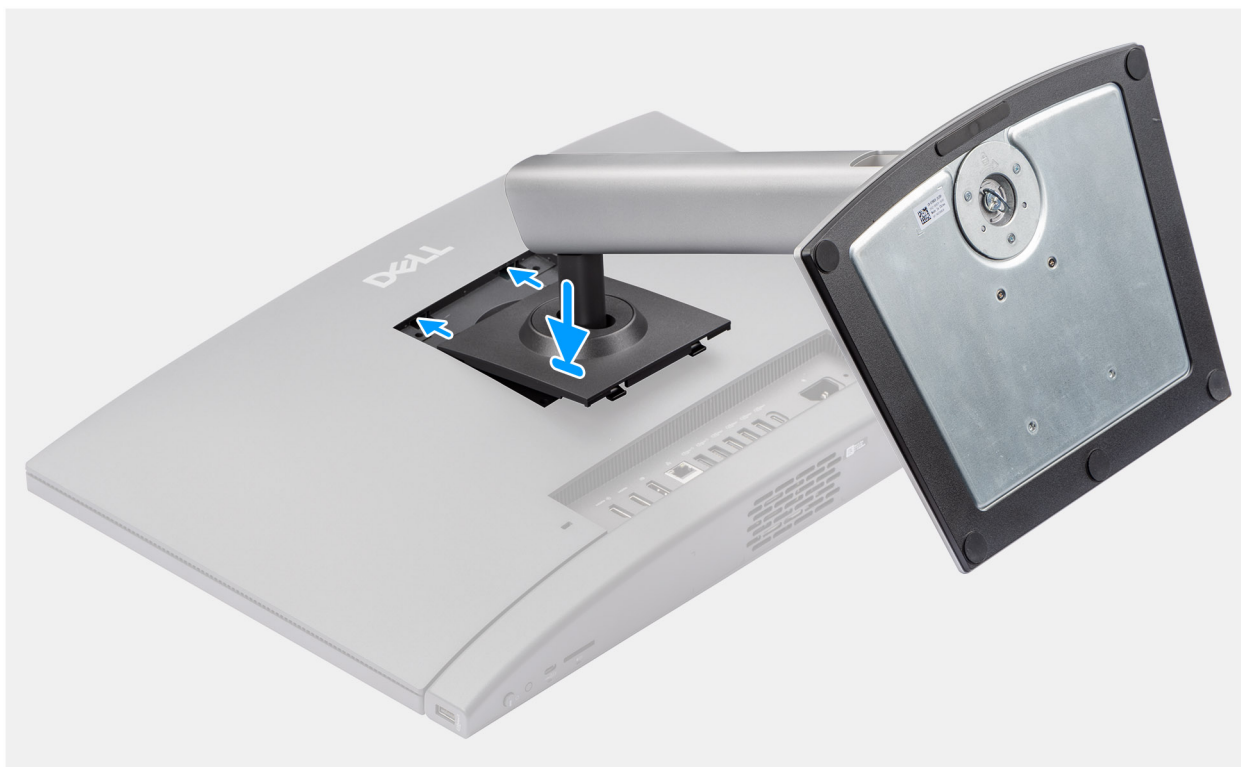
Obrázek 15. Instalace výškově nastavitelného stojanu (HAS)
