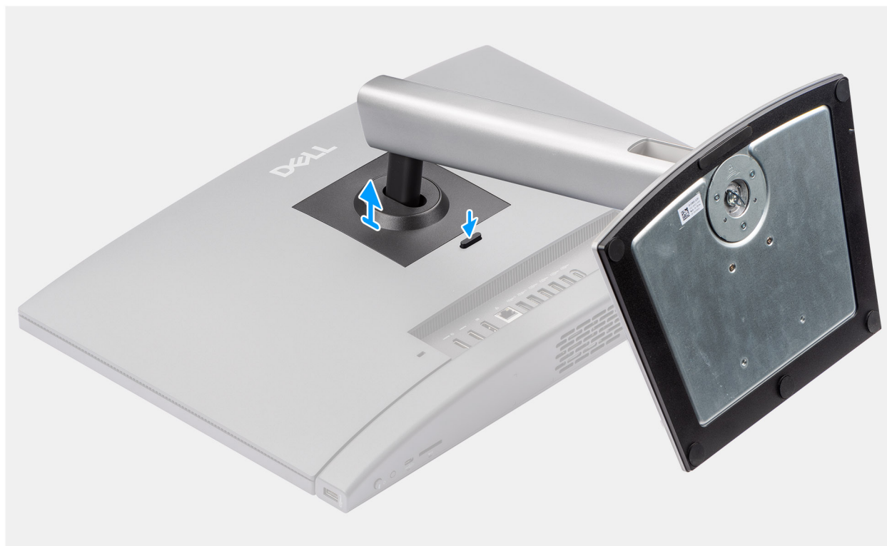
Obrázek 13. Demontáž výškově nastavitelného stojanu (HAS)
