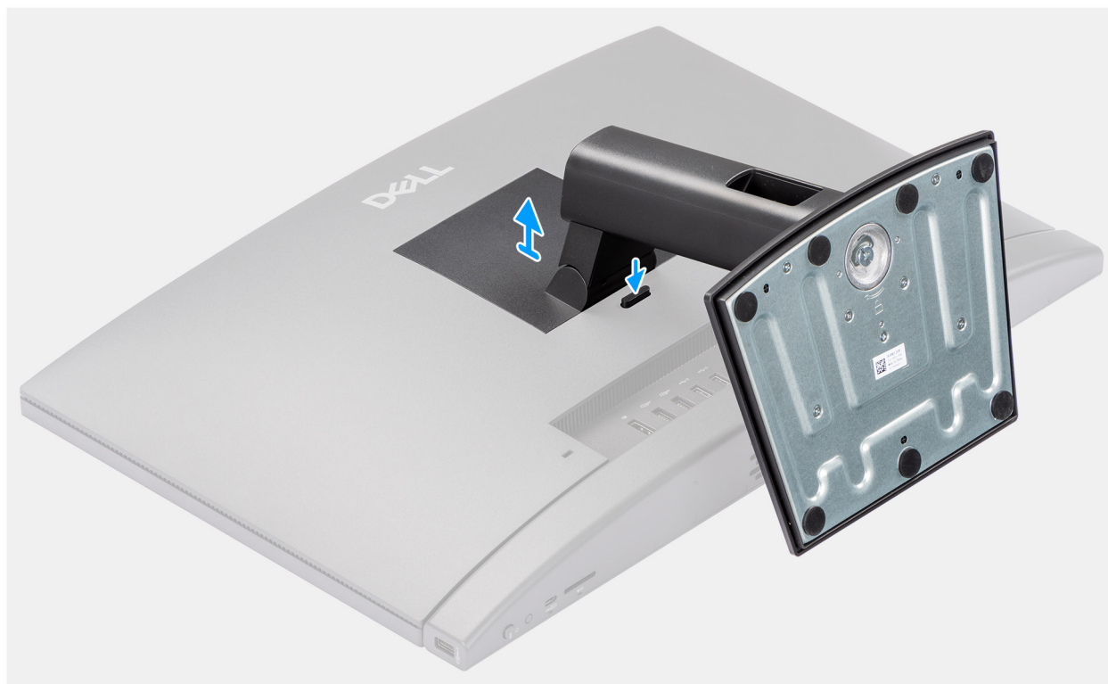
Obrázek 14. Demontáž pevného stojanu
