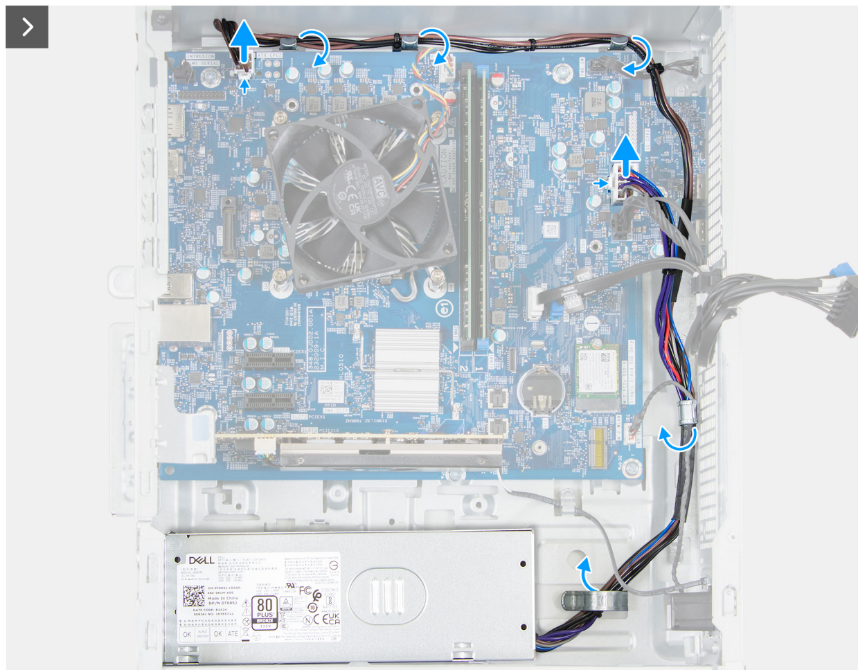
Obrázek 61. Demontáž napájecího zdroje
