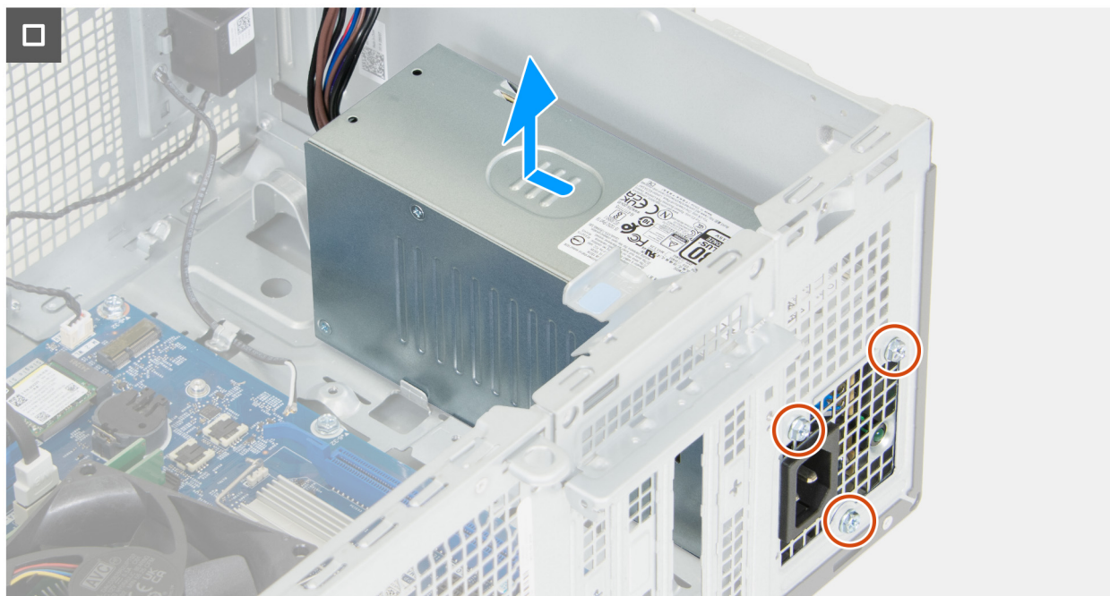
Obrázek 62. Demontáž napájecího zdroje
