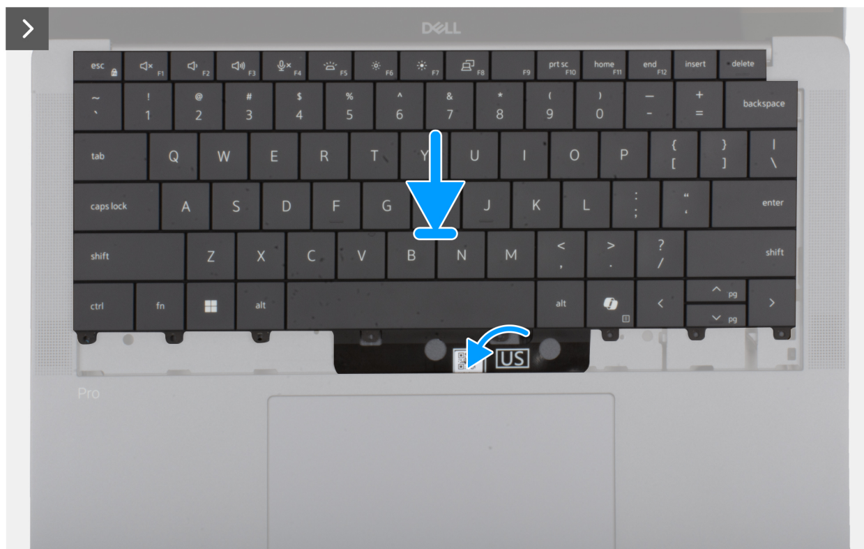
Figure 73. Installation de l'assemblage du clavier
