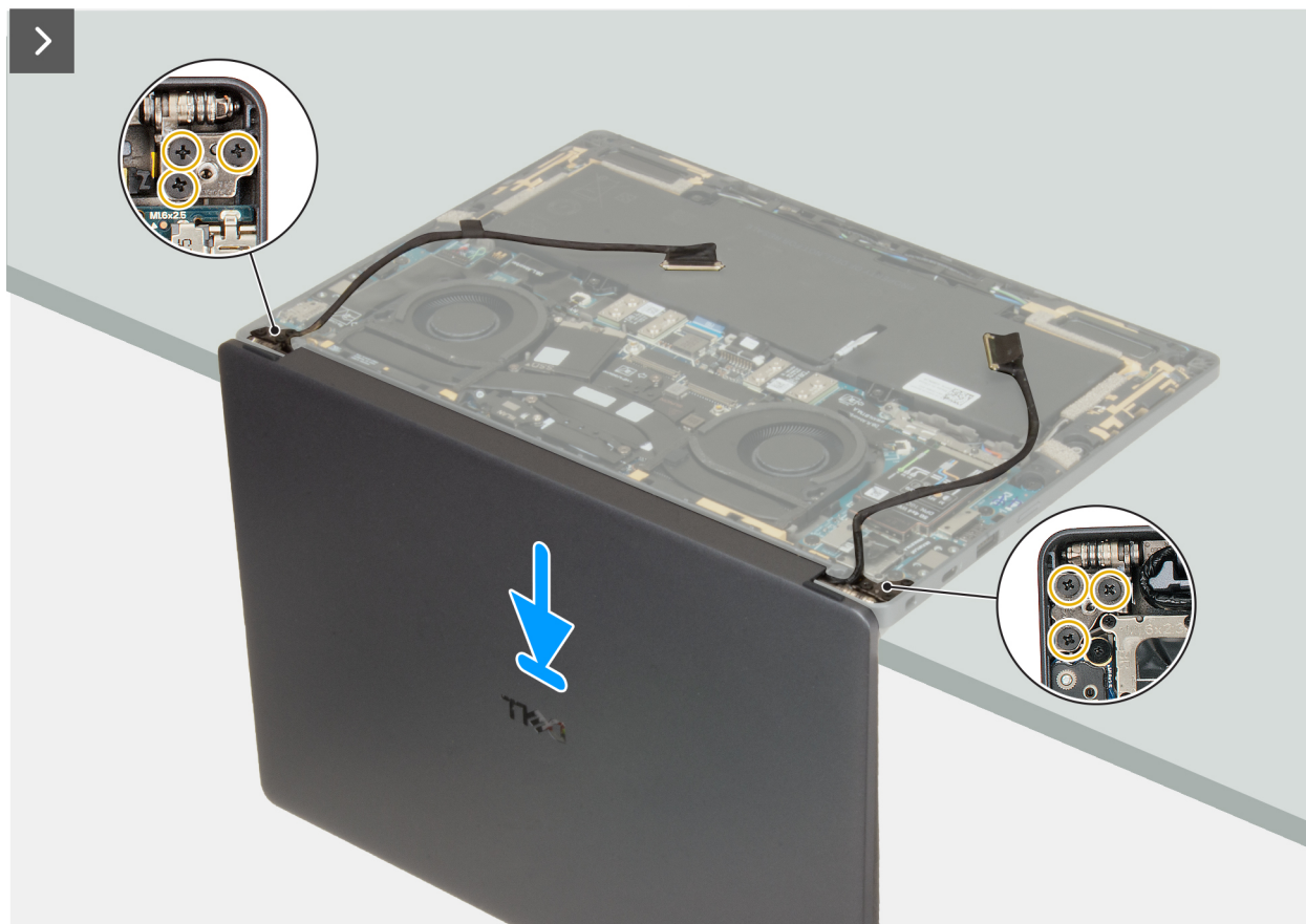
Figure 59. Installation de l'assemblage d'écran
