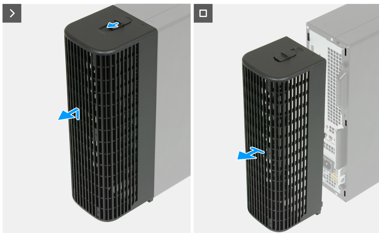
Obrázek 4. Demontáž krytu kabeláže
