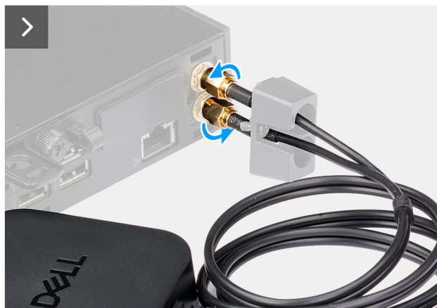
Rysunek 34. Wymontowywanie zewnętrznej anteny krążkowej
