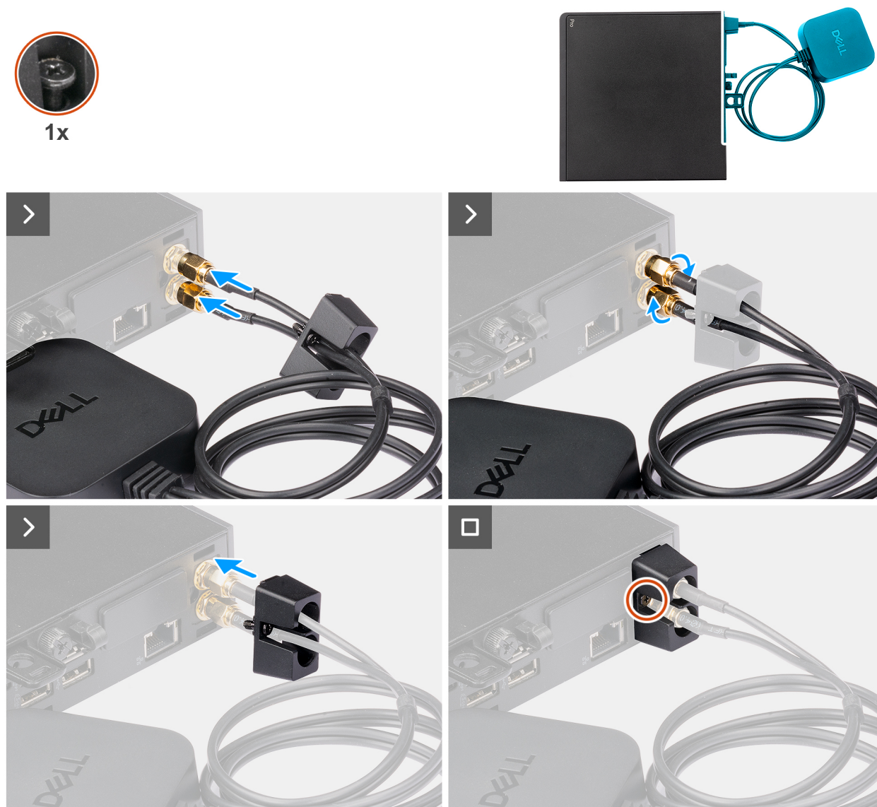
Rysunek 35. Instalowanie zewnętrznej anteny krążkowej
