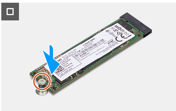
איור 21. התקנת כונן ה- solid state סוג M.2 2280
