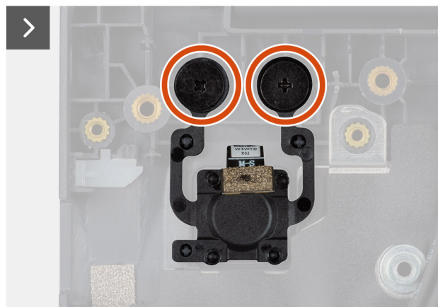
Rysunek 44. Wymontowywanie przycisku zasilania z czytnikiem linii papilarnych
