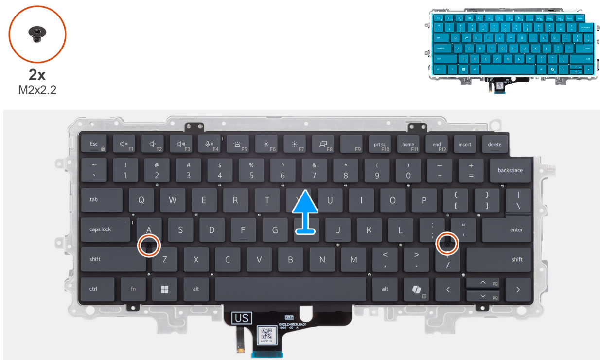
Rysunek 66. Wymontowywanie płyty nośnej klawiatury
