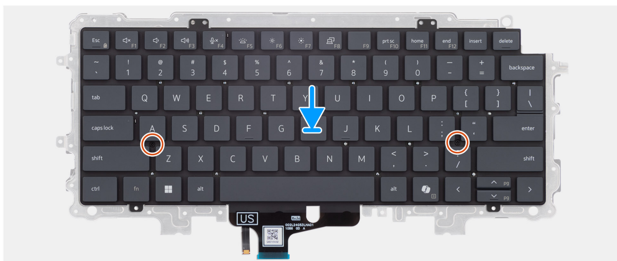
Rysunek 69. Instalowanie płyty nośnej klawiatury
