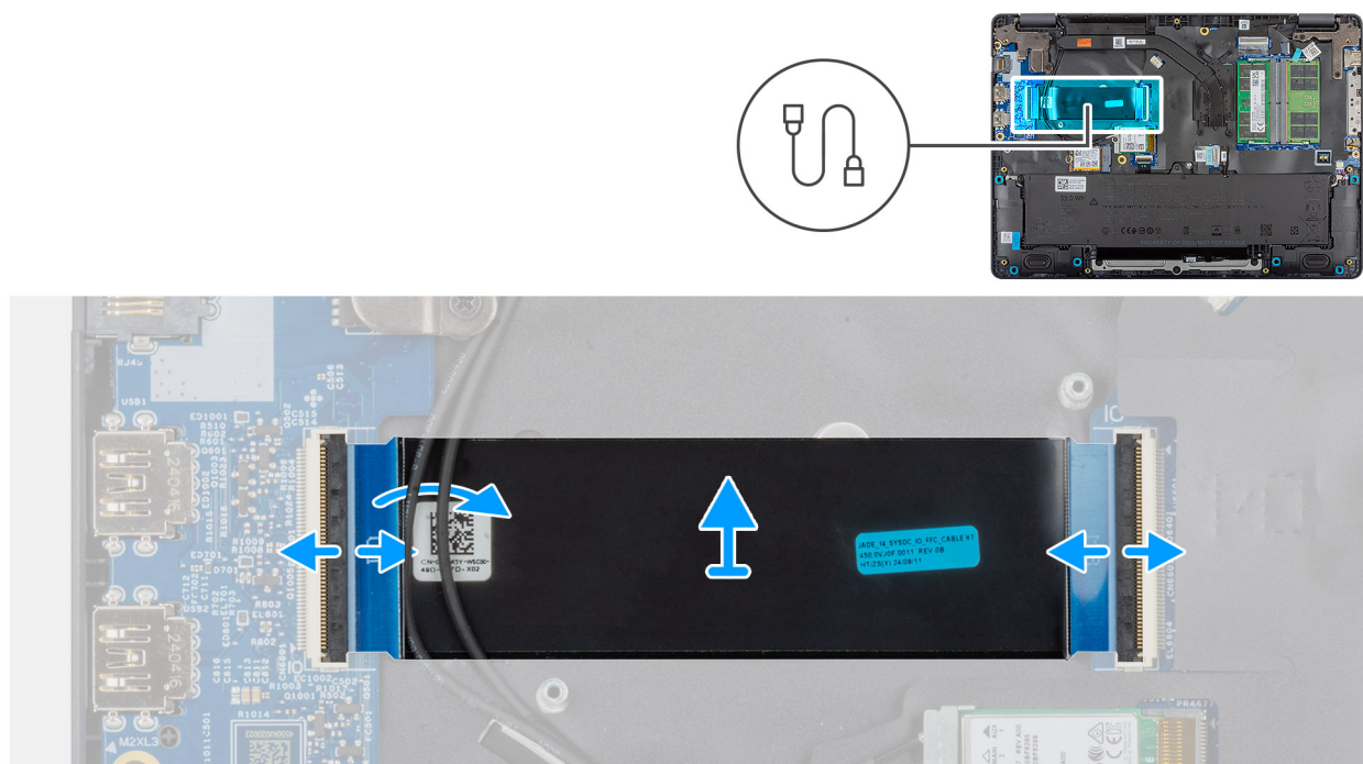
Rysunek 42. Wymontowywanie kabla FPC płyty we/wy
