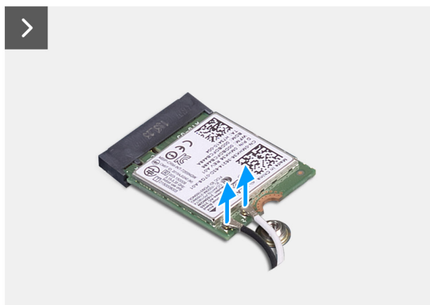
Rysunek 25. Wymontowywanie karty sieci bezprzewodowej
