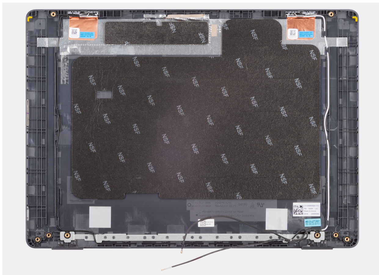
Rysunek 97. Instalowanie zestawu pokrywy tylnej wyświetlacza
