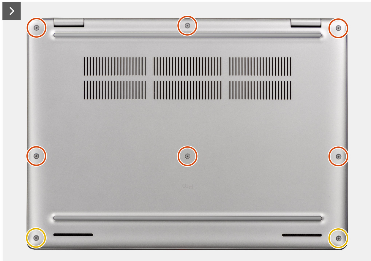
איור 22. Removing the base cover
