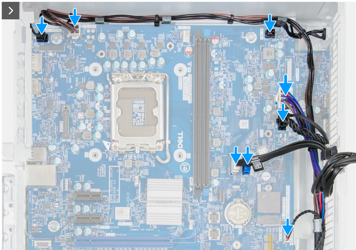
איור 77. התקנת לוח המערכת
