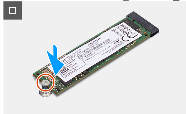
איור 31. התקנת כונן ה-solid state מסוג M.2 2280
