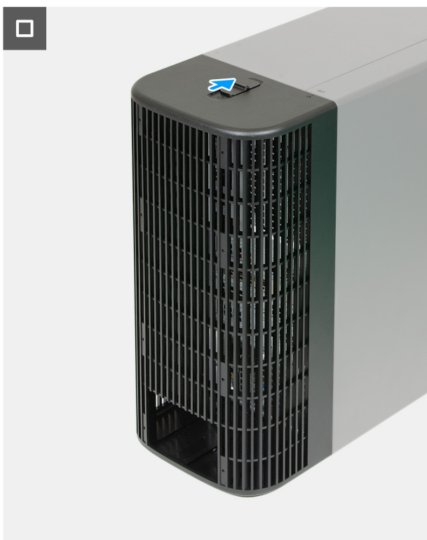
איור 11. התקנת כיסוי הכבלים
