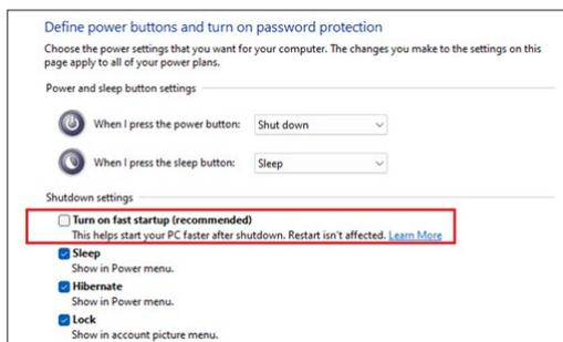
Wenn der Schnellstart deaktiviert ist, wird der Computer beim Herunterfahren in den S5-Energiezustand heruntergefahren.
