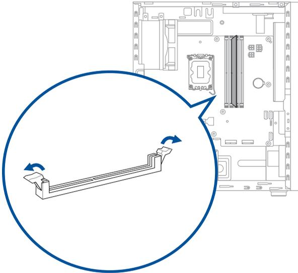
7. Richten Sie die Einkerbung am unteren Rand des DIMMs an der Nase im DIMM-Steckplatz aus, und stecken Sie dann das DIMM fest in den Steckplatz ein, bis der Auswerfer wieder einrastet.
