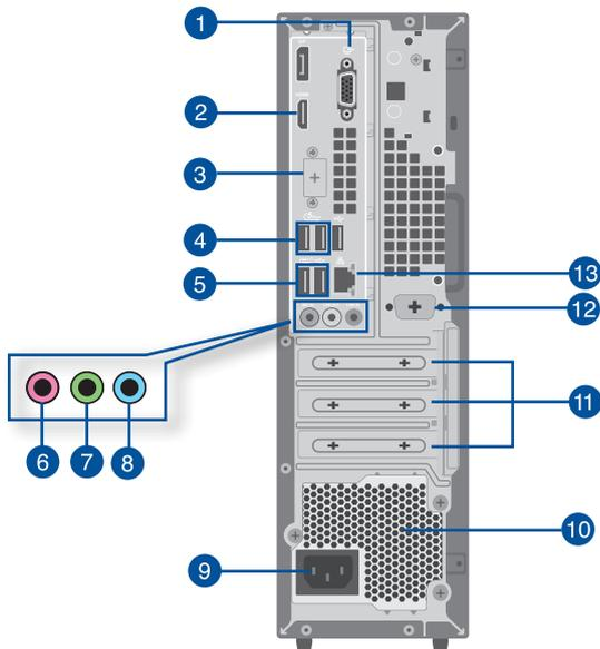
1. **VGA-Anschluss.** Dieser Anschluss ist für einen VGA-Monitor oder andere VGA-kompatible Geräte vorgesehen.
