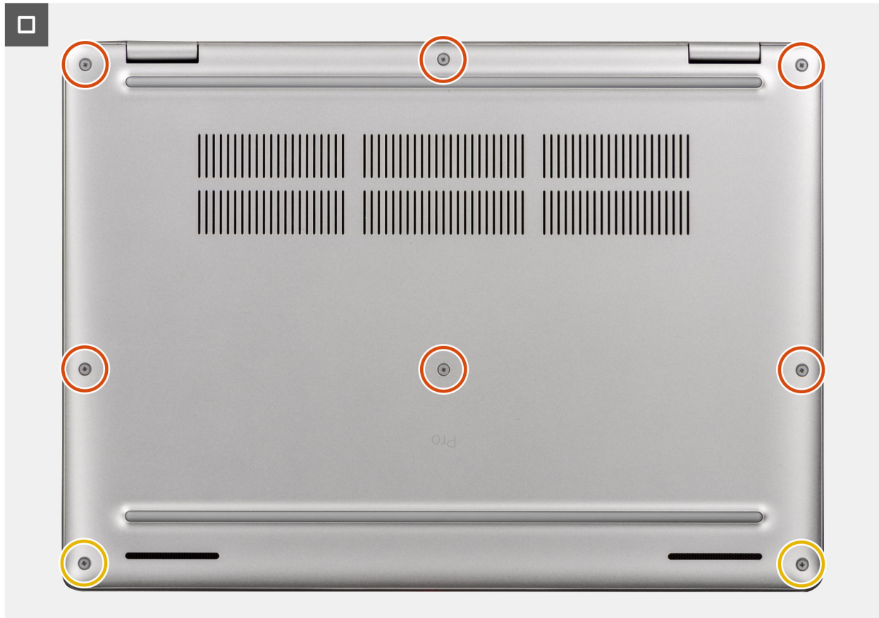
Ilustración 26. Instalación de la cubierta de la base
