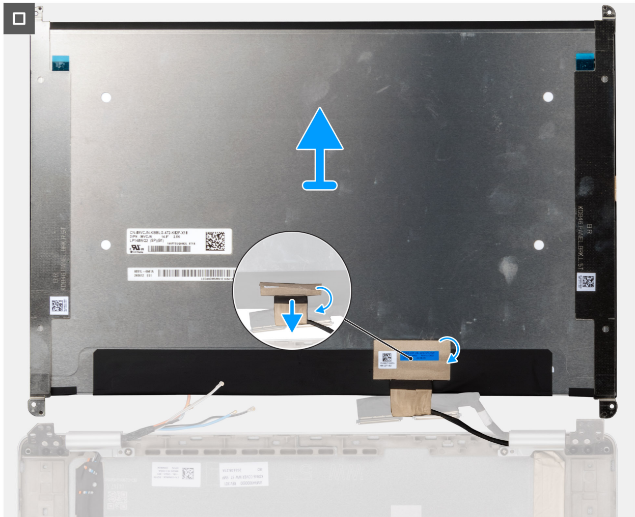
Ilustración 69. Extracción del panel de pantalla
