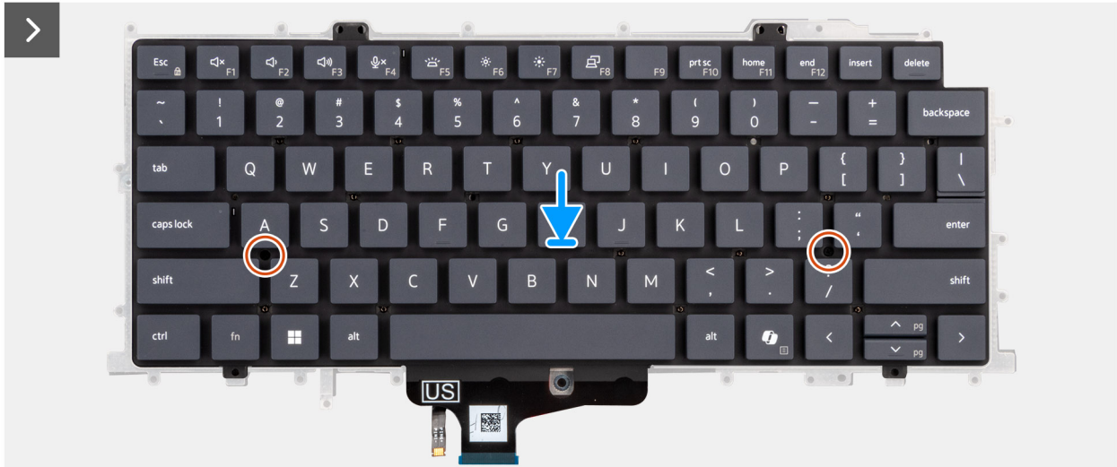
Ilustración 83. Instalación del teclado
