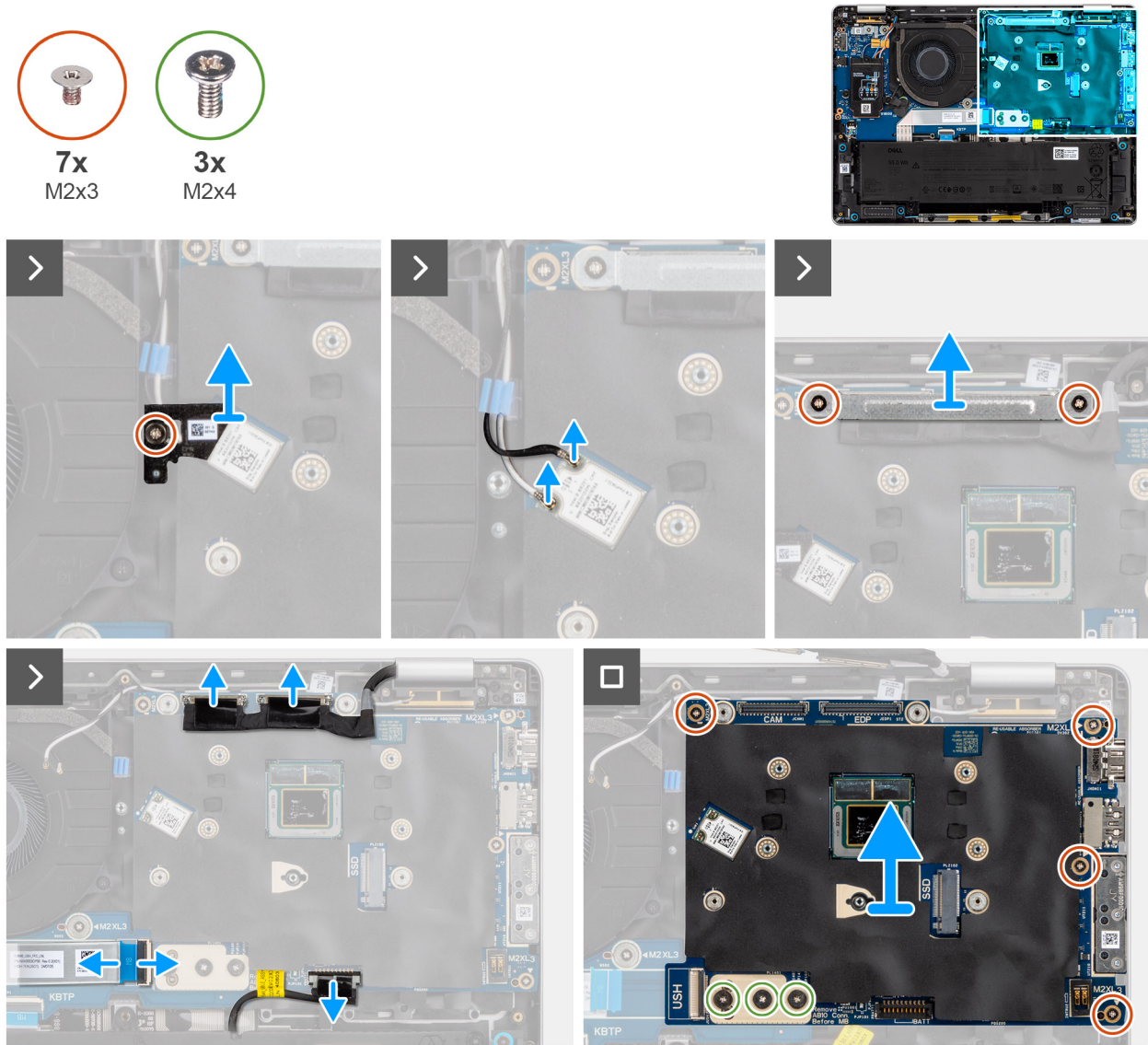
Ilustración 48. Extracción de la tarjeta madre
