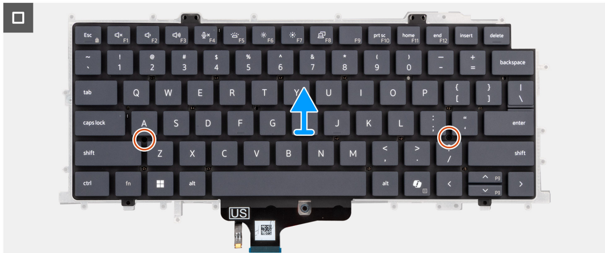
Ilustración 82. Extracción del teclado
