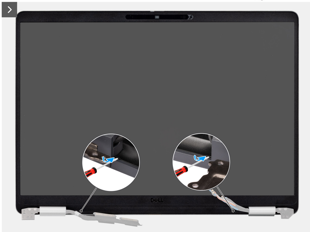
Ilustración 61. Extracción del embellecedor de la pantalla
