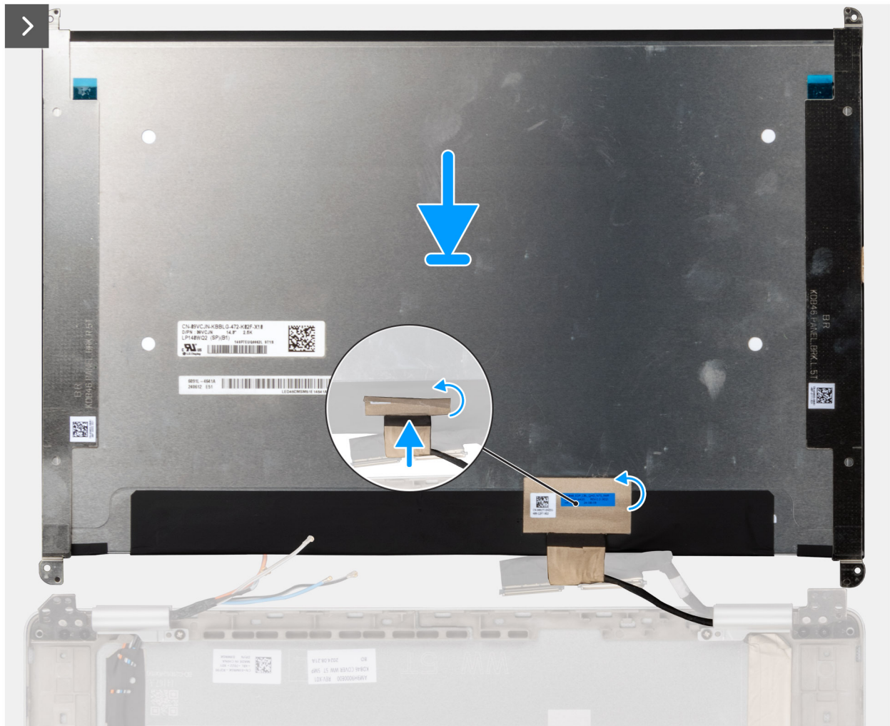
Ilustración 71. Instalación del panel de pantalla
