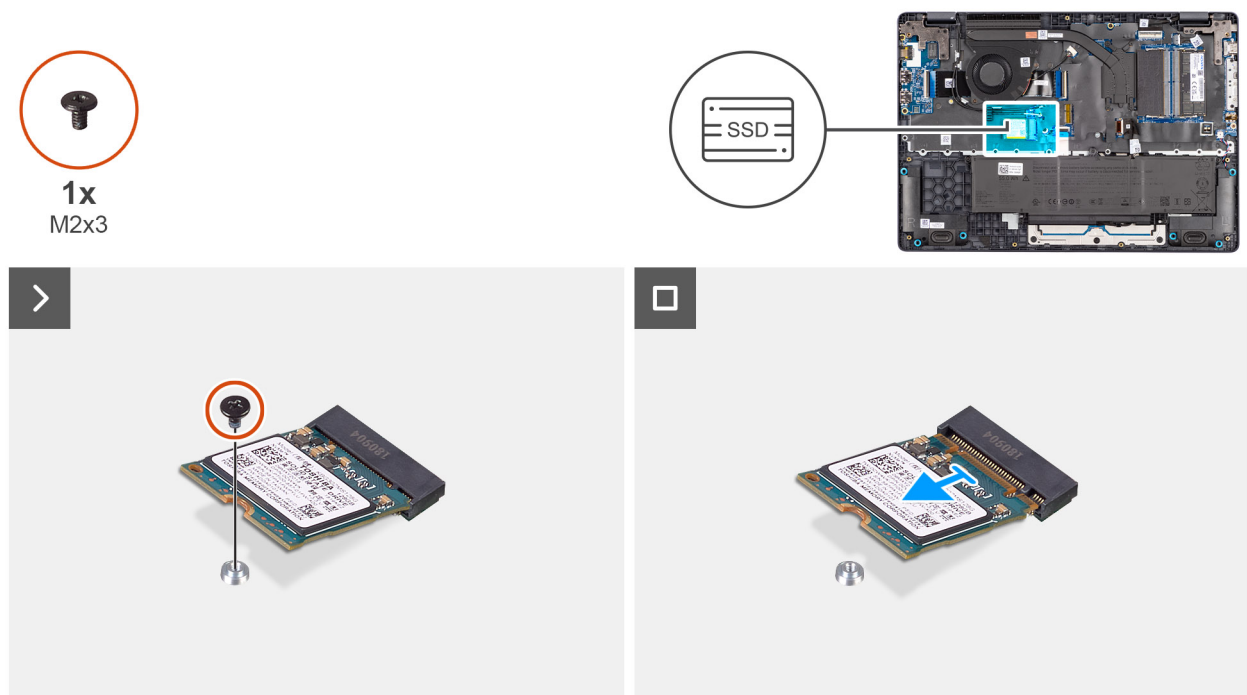
Ilustración 23. Removing the SSD
