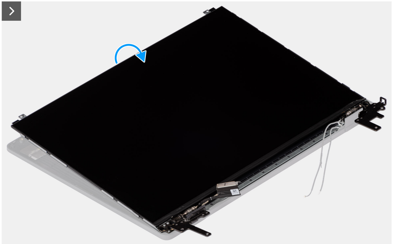
Ilustración 75. Removing the display-panel assembly
