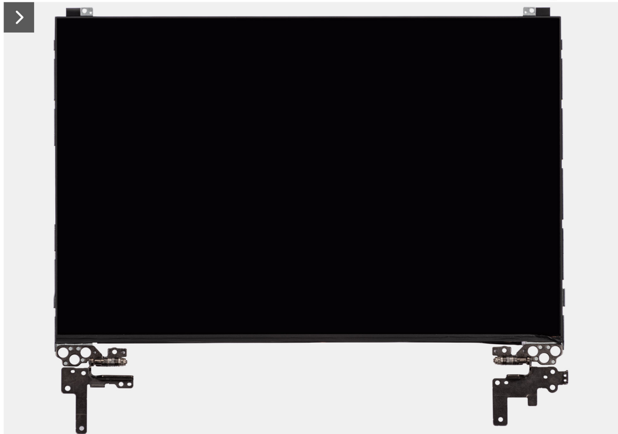
Ilustración 78. Installing the display-panel assembly
