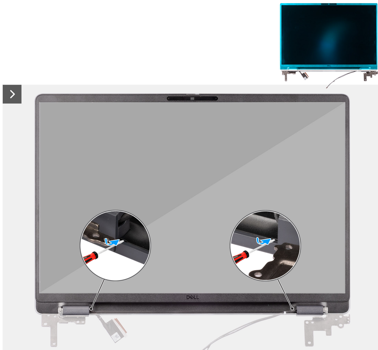
Ilustración 67. Removing the display bezel
