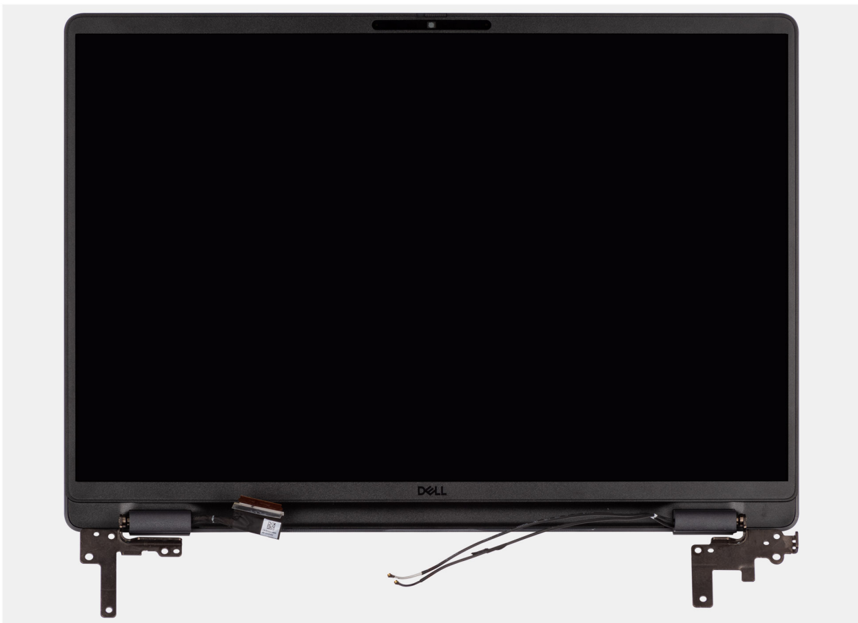
Ilustración 64. Removing the display assembly
