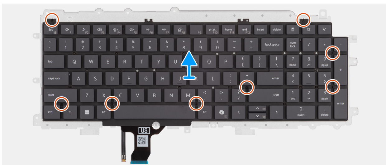
Ilustración 56. Removing the keyboard support plate
