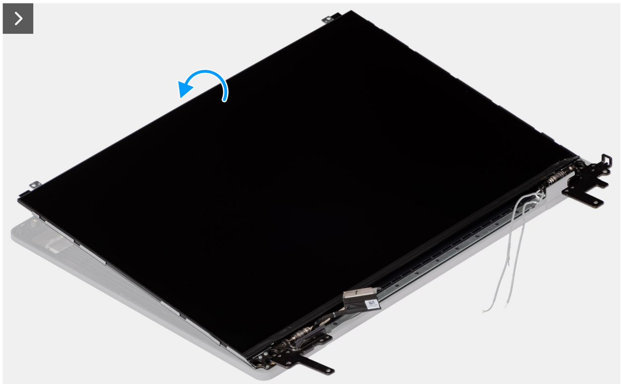
Ilustración 80. Installing the display-panel assembly
