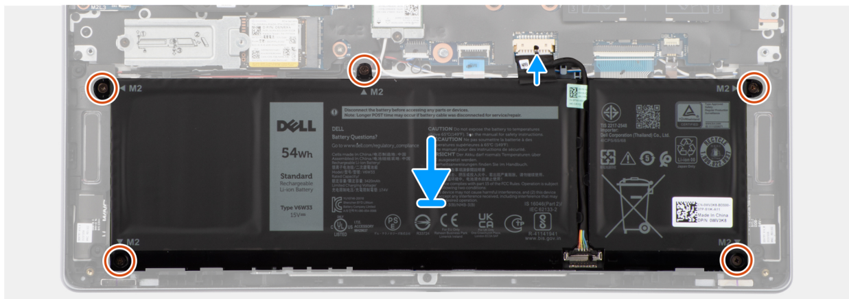
Ilustración 26. Instalación de la batería
