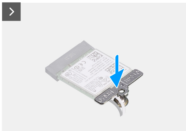
Ilustración 22. Instalación de la tarjeta inalámbrica
