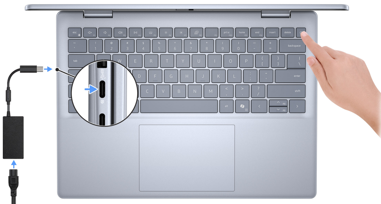
Ilustración 11. Conecte el adaptador de alimentación y presione el botón de encendido
