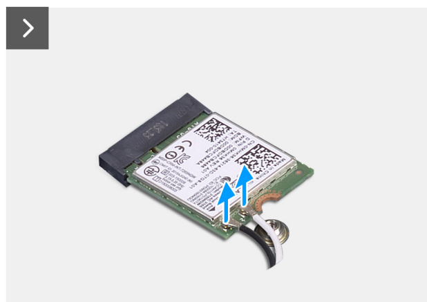
Ilustración 21. Extracción de la tarjeta inalámbrica
