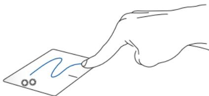
Doppeltippen Sie auf ein Element, wischen Sie dann mit demselben Finger, ohne den Finger vom Touchpad zu lösen. Legen Sie das Element an seinem neuen Ort ab, indem Sie Ihren Finger vom Touchpad lösen.
