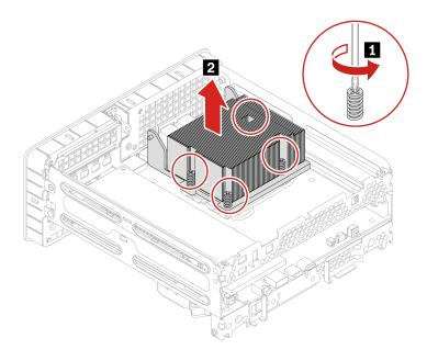
• 125-watt heat sink and fan assembly
