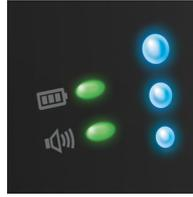
Controlla che il monitor sia connesso. Se la spia verde si illumina è connesso, se invece lampeggia la spia rossa significa che non è connesso
