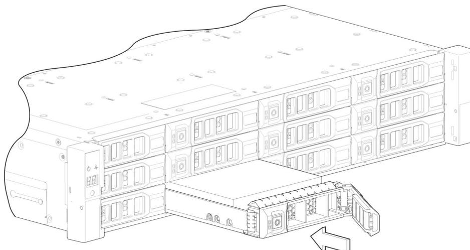
**Figure 41. Installation d'un module de support de lecteur LFF (1 sur 2)**
