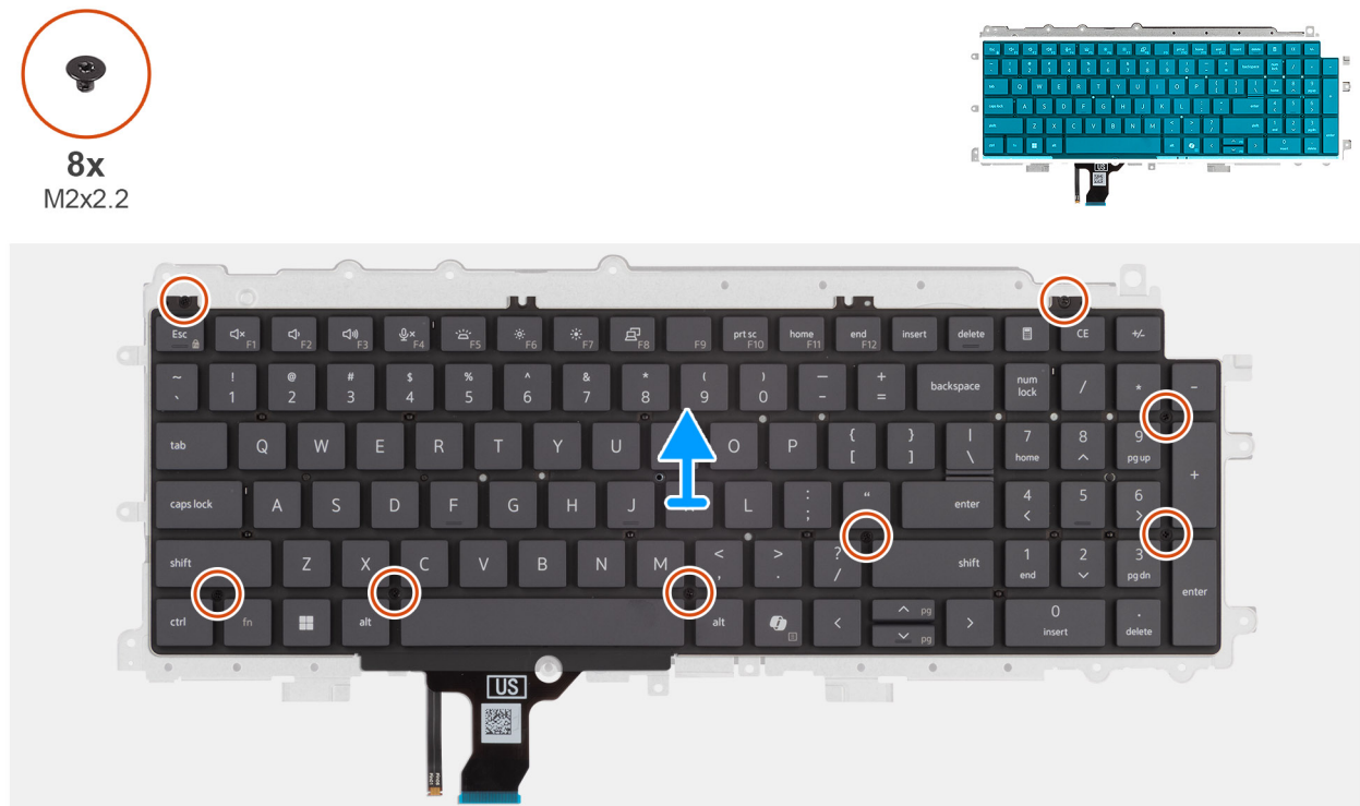
Afbeelding 66. Removing the keyboard support plate
