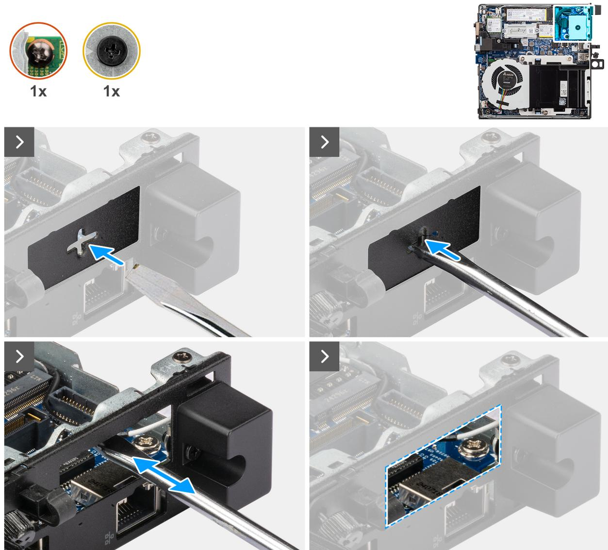
Figure 54. Installation du module de port PS2
