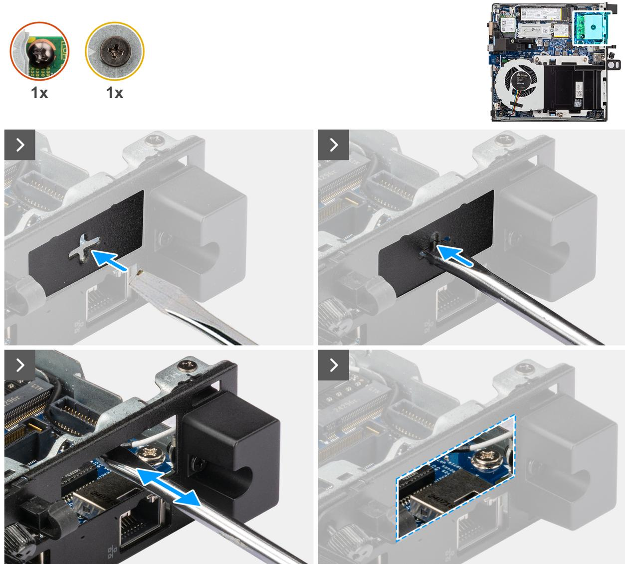
Figure 45. Installation du module DisplayPort
