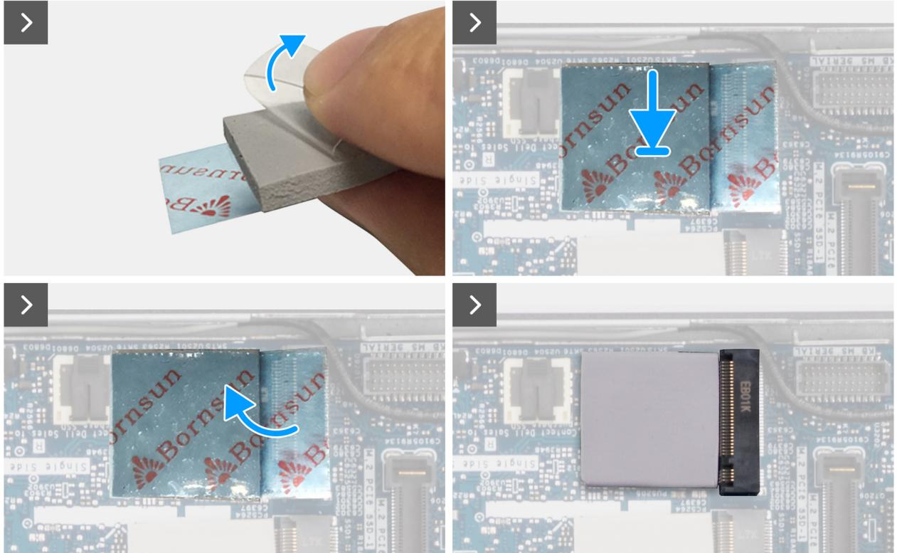
Figure 20. Installation du disque SSD M.2 2280
