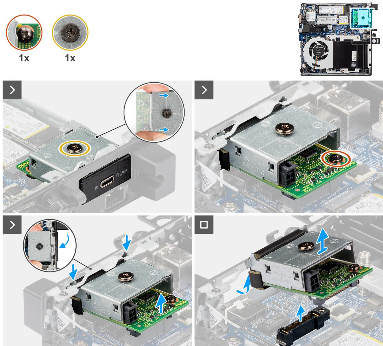
Figure 41. Retrait du module de port USB-C
