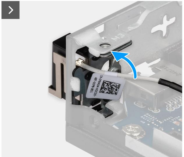
Figure 68. Installation du module d'antenne (câble blanc)
