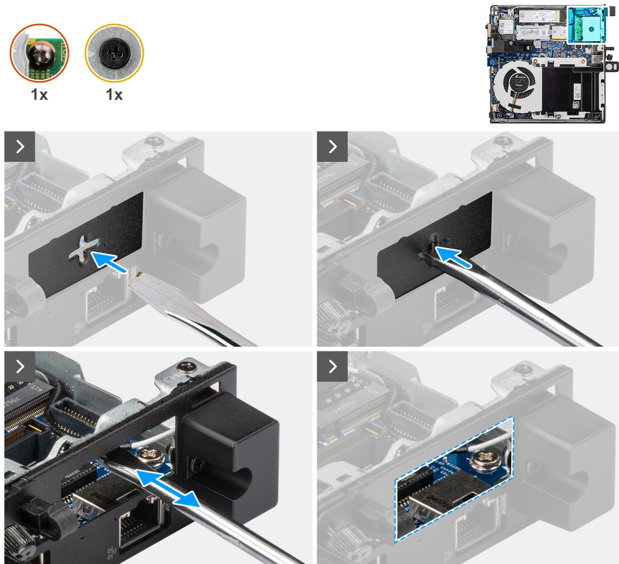
Figure 51. Installation du module de port VGA
