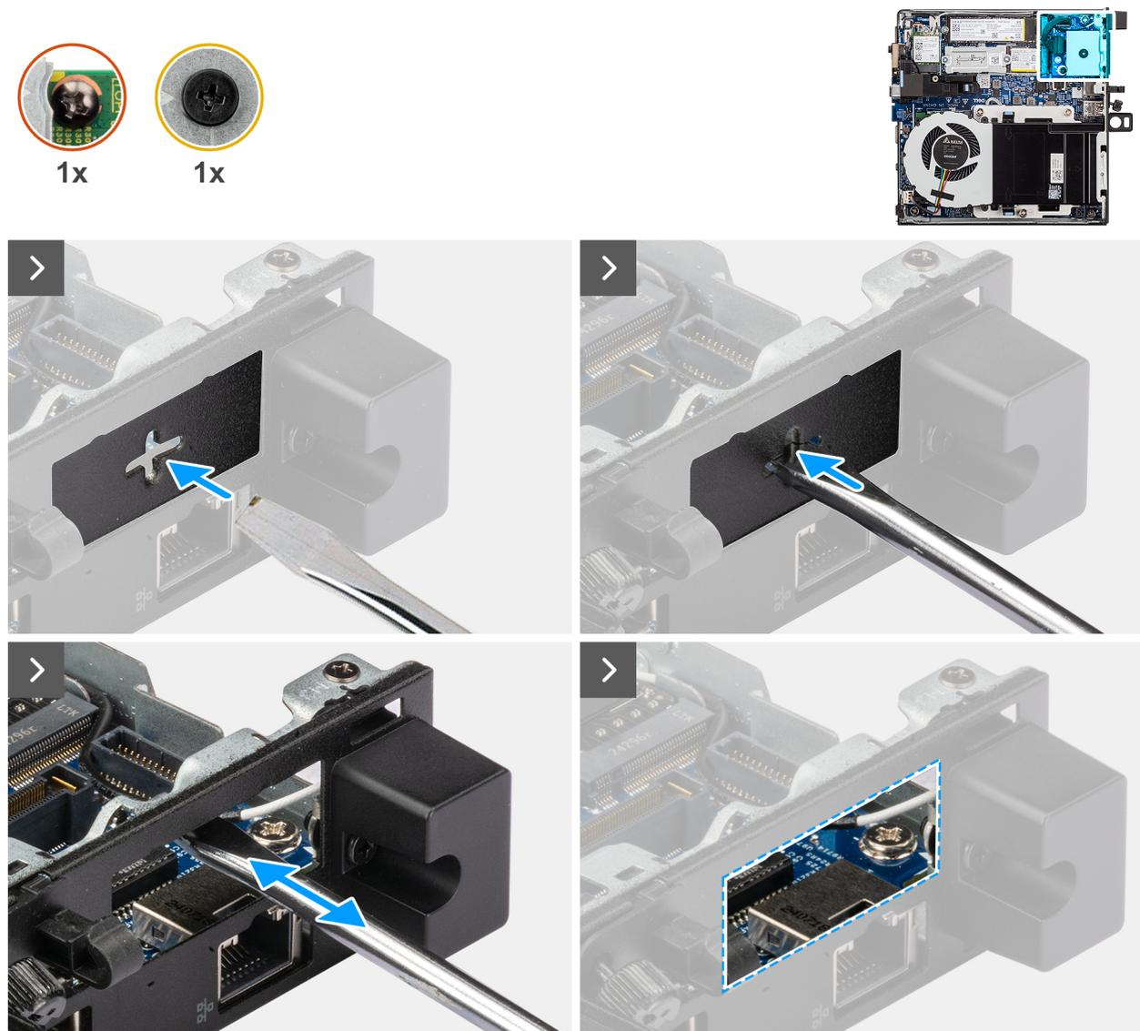
Figure 57. Installation du module de port série
