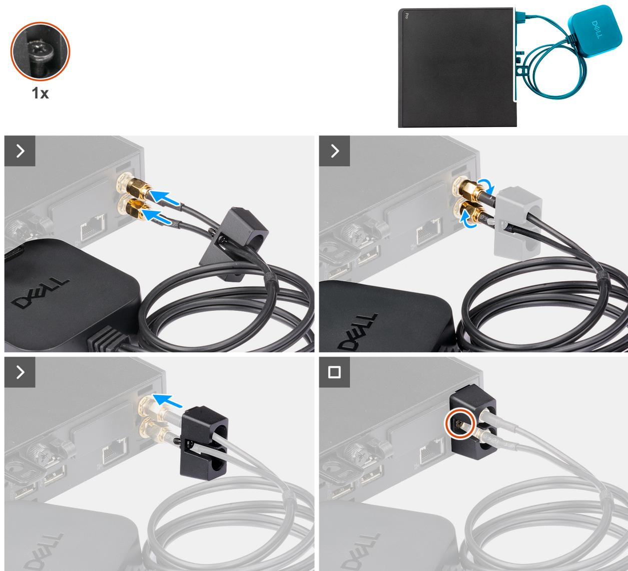
Figure 35. Installation de l'antenne Puck externe
