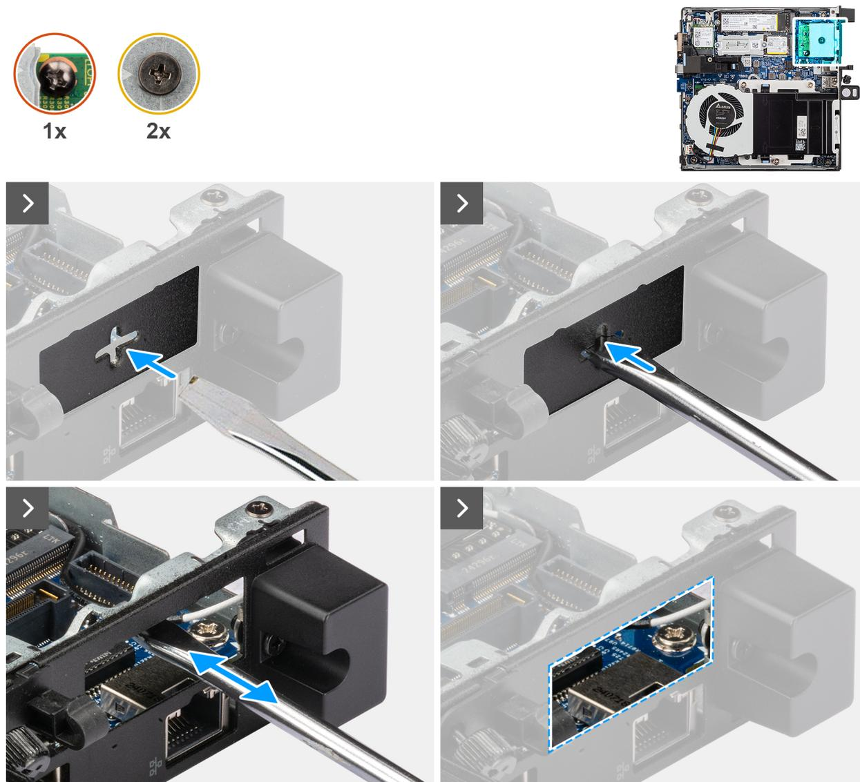
Figure 60. Installation du module de port fibre optique
