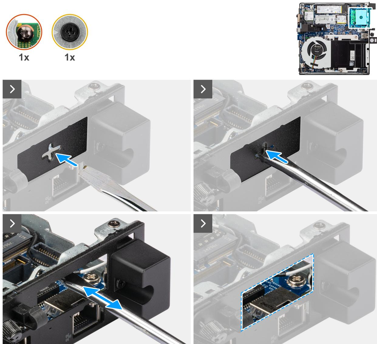
Figure 48. Installation du module de port HDMI
