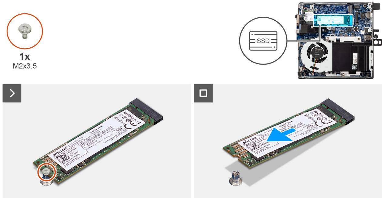
Figure 19. Retrait du disque SSD M.2 2280
