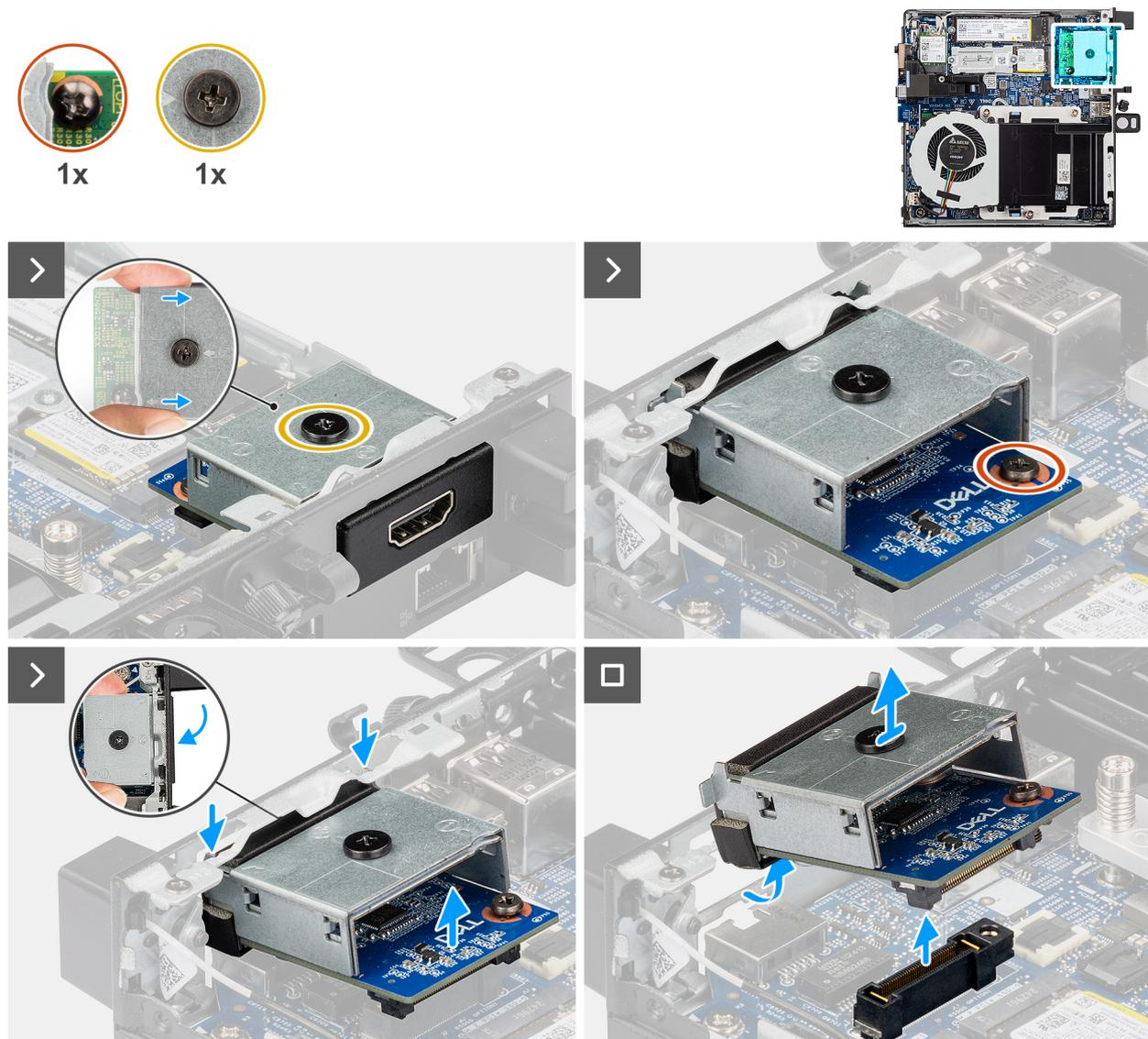
Figure 47. Retrait du module de port HDMI
