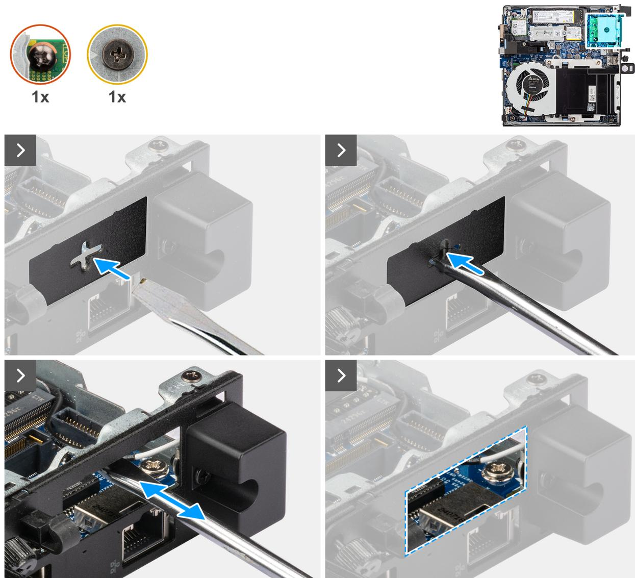
Figure 42. Installation du module de port USB-C
