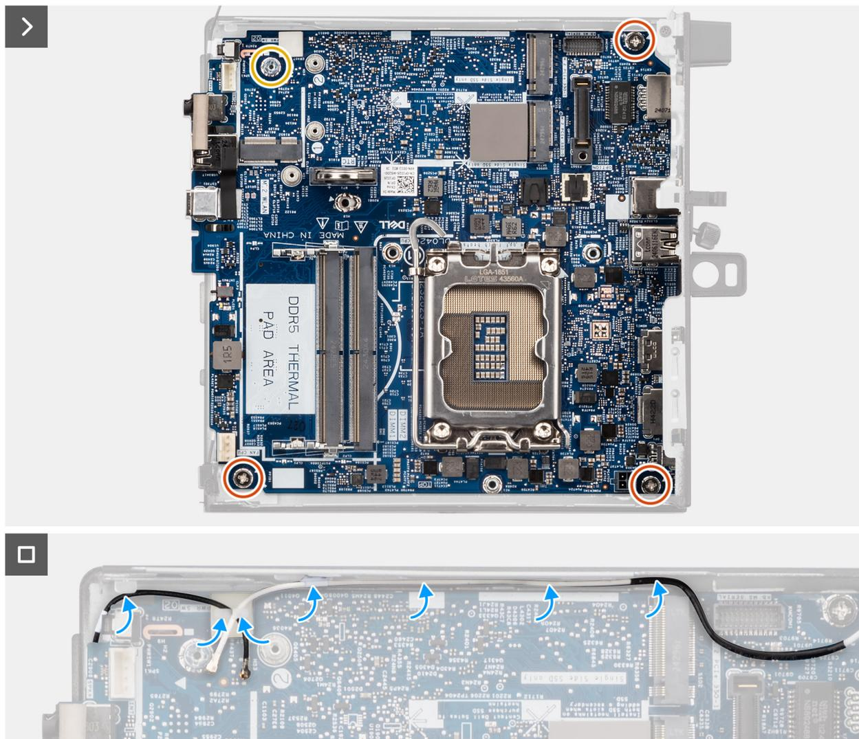
**Figure 79. Installation de la carte système**
