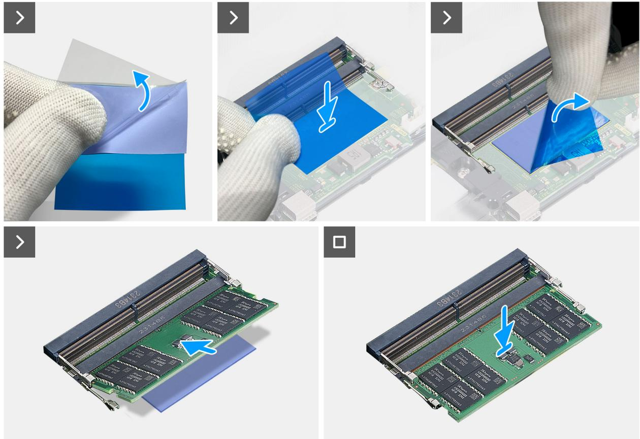
Figure 33. Installation du module de mémoire
