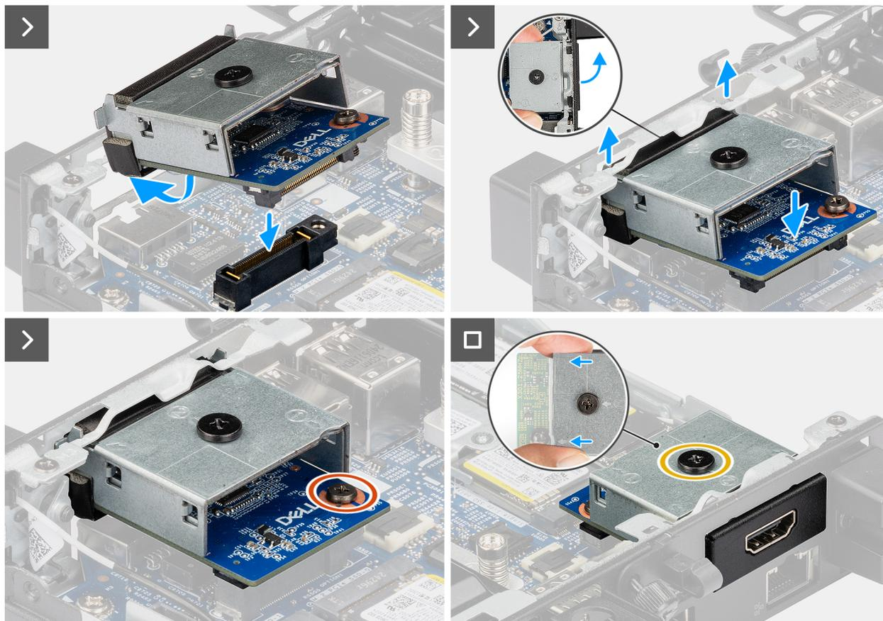
Figure 49. Installation du module de port HDMI
