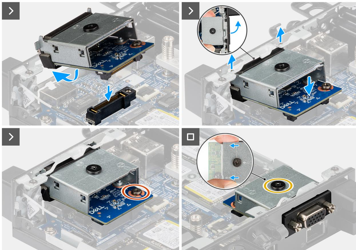
Figure 52. Installation du module de port VGA
