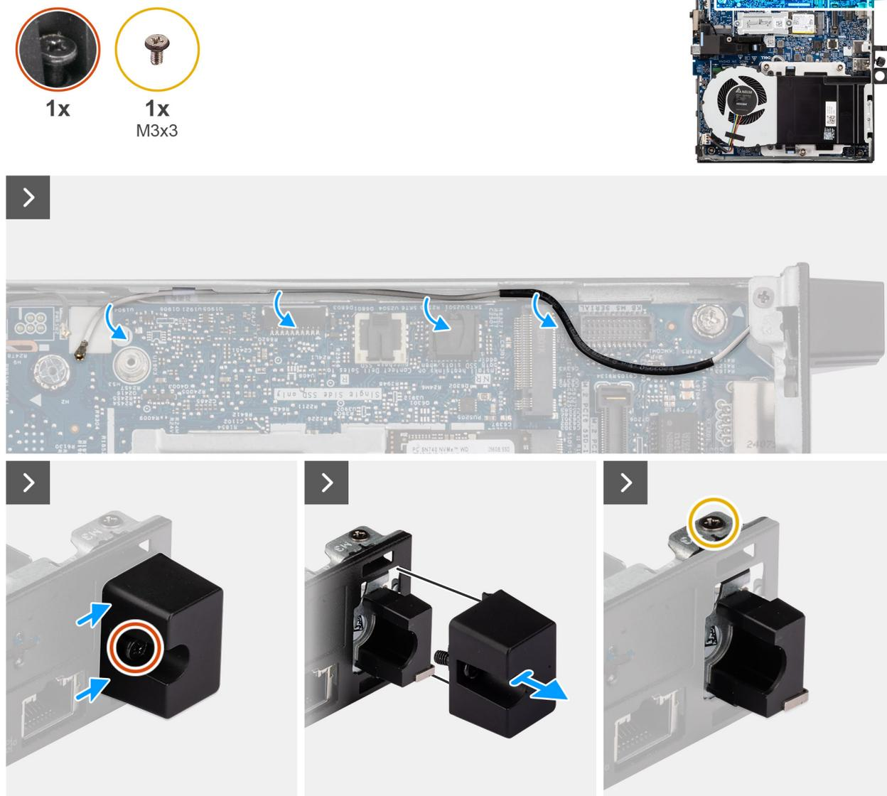
Figure 66. Retrait du module d'antenne (câble blanc)
