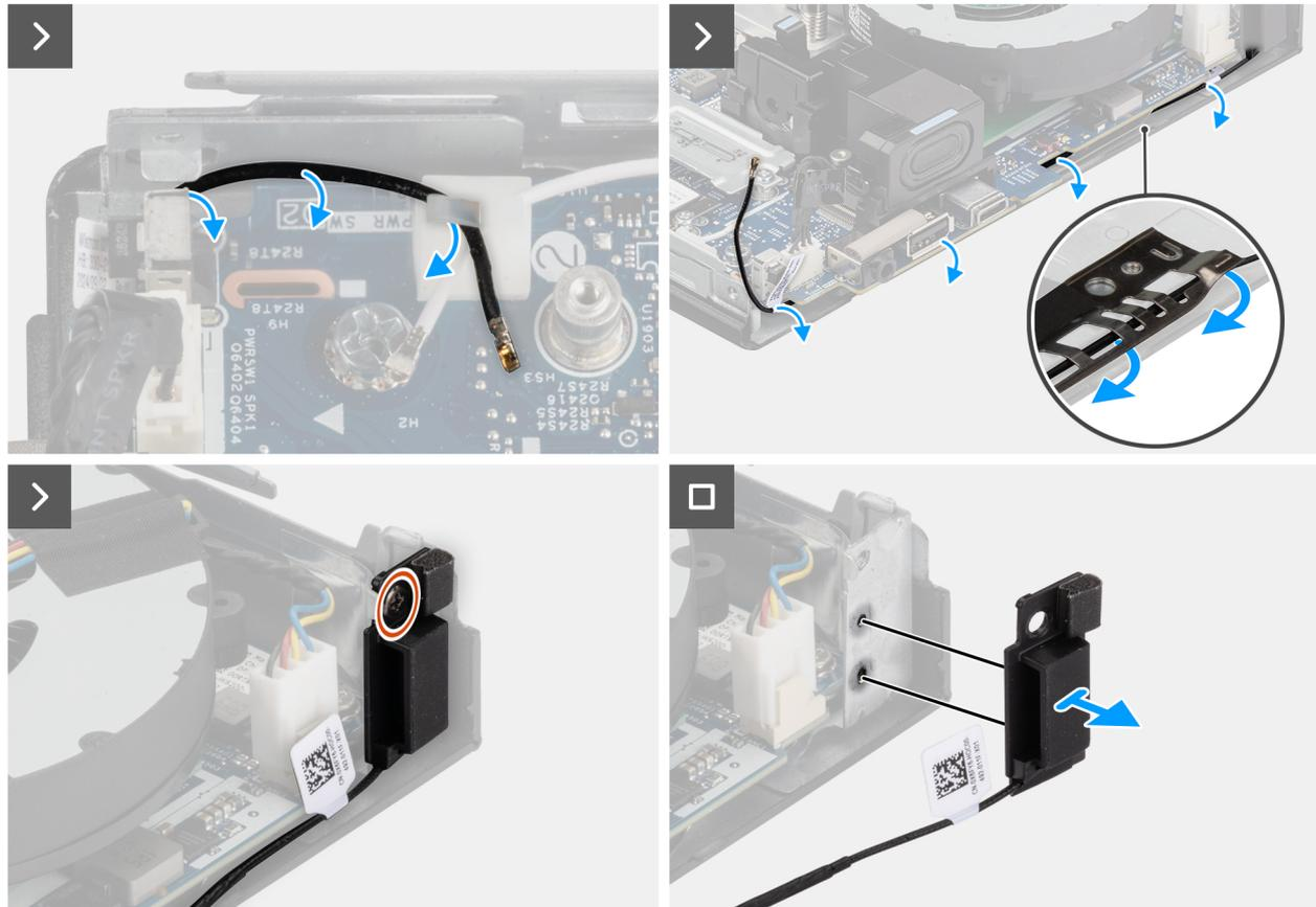
Figure 64. Retrait du module d'antenne (câble noir)
