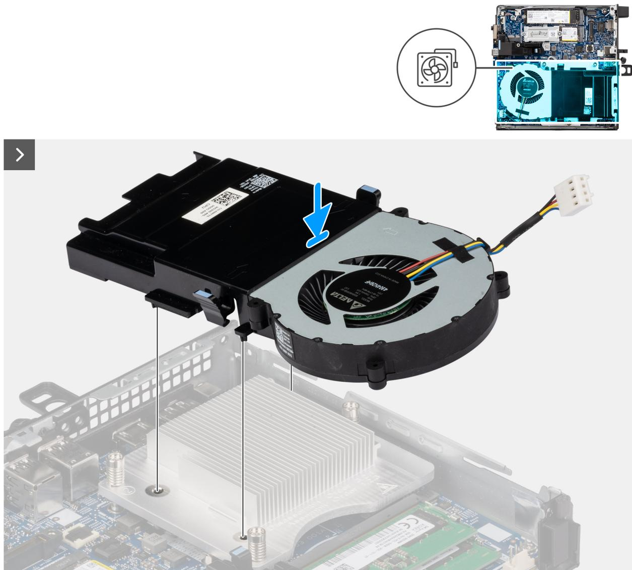
Figure 30. Installation du ventilateur
