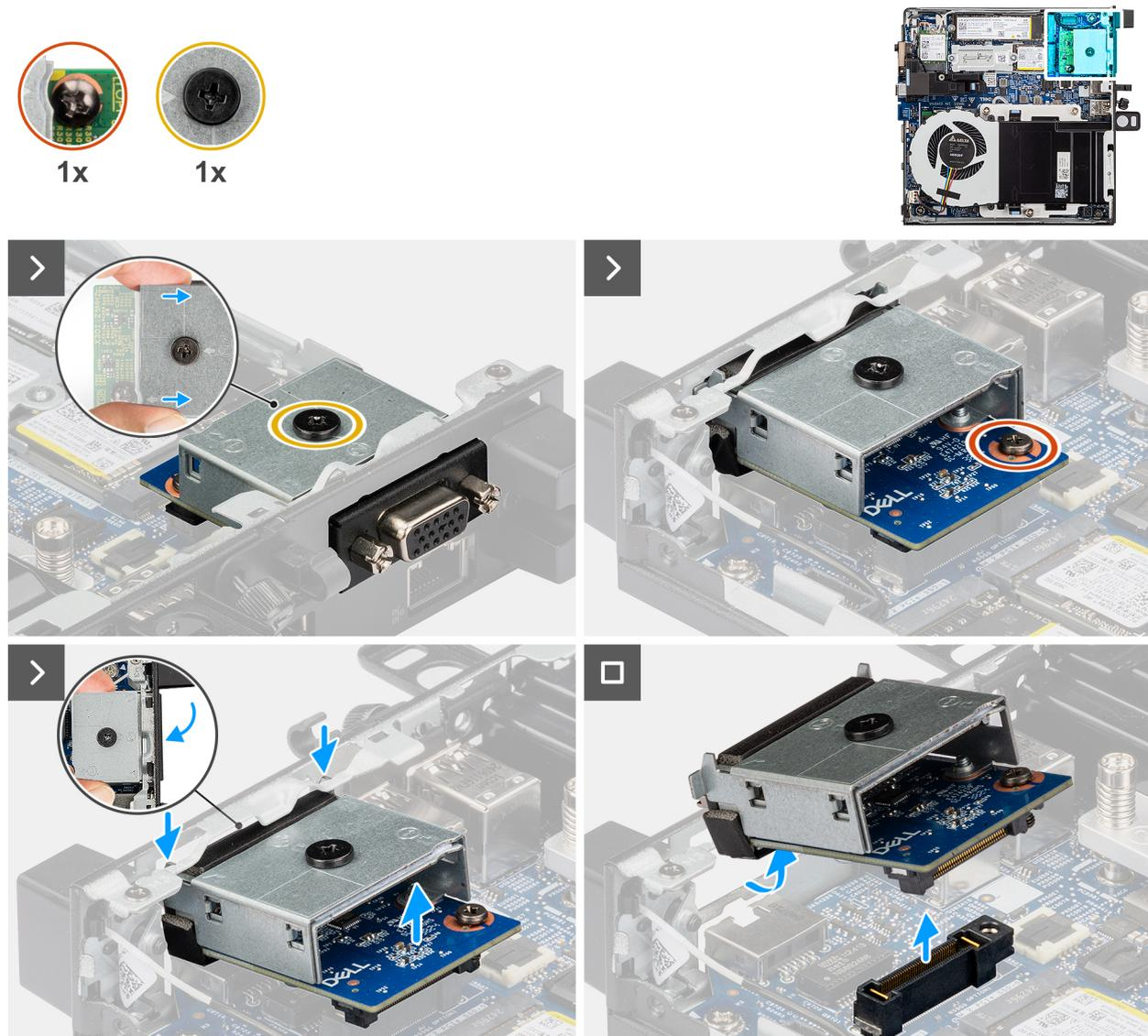
Figure 50. Retrait du module de port VGA
