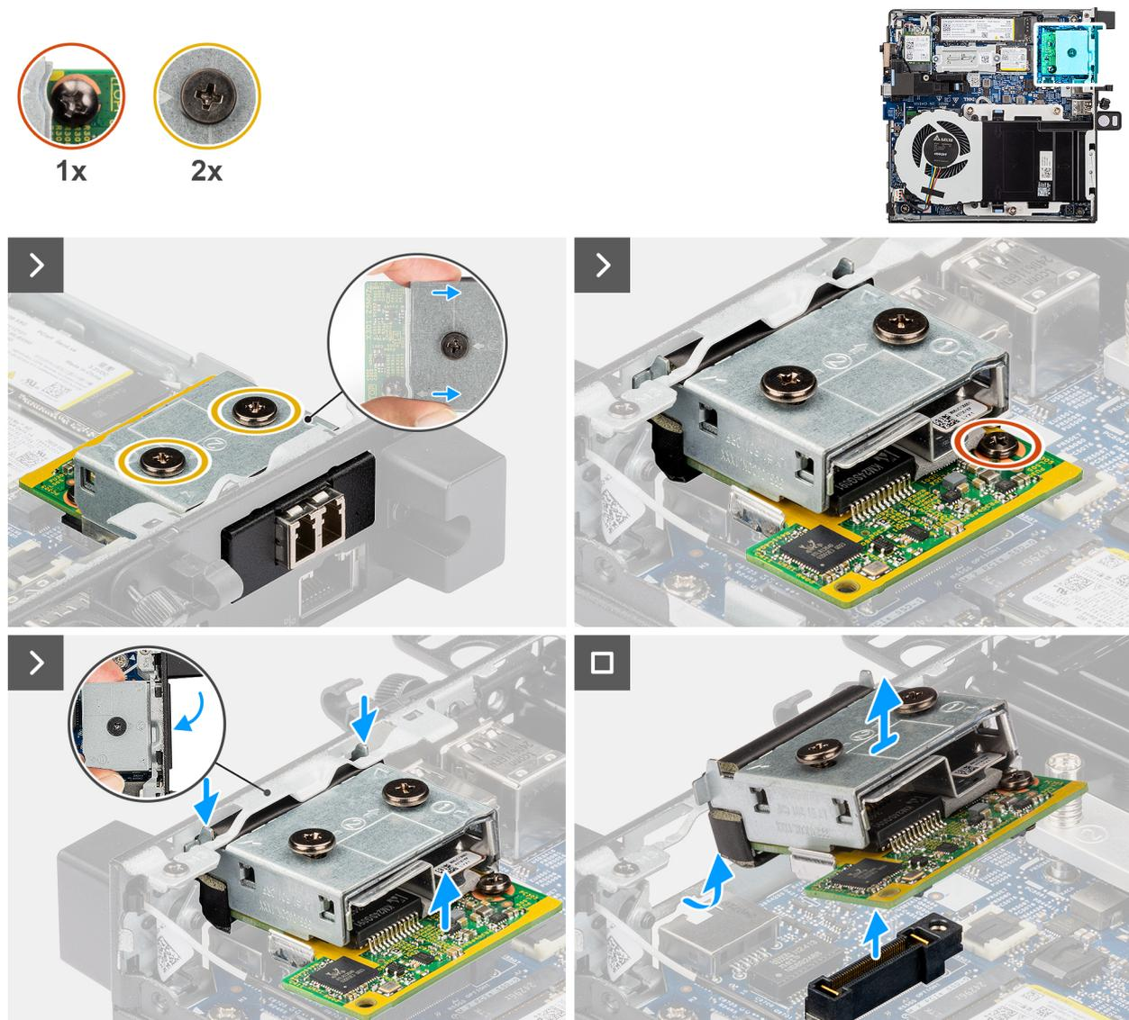
Figure 59. Retrait du module de port fibre optique
