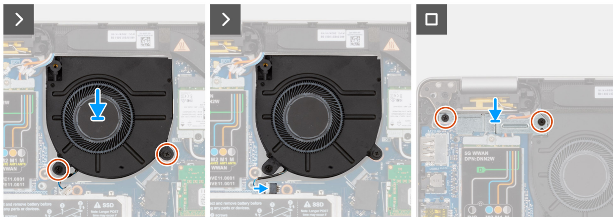
Afbeelding 42. De ventilator installeren
