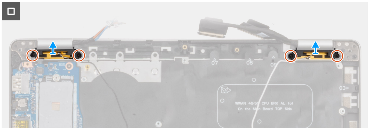
Afbeelding 60. De draadloze antennemodule verwijderen
