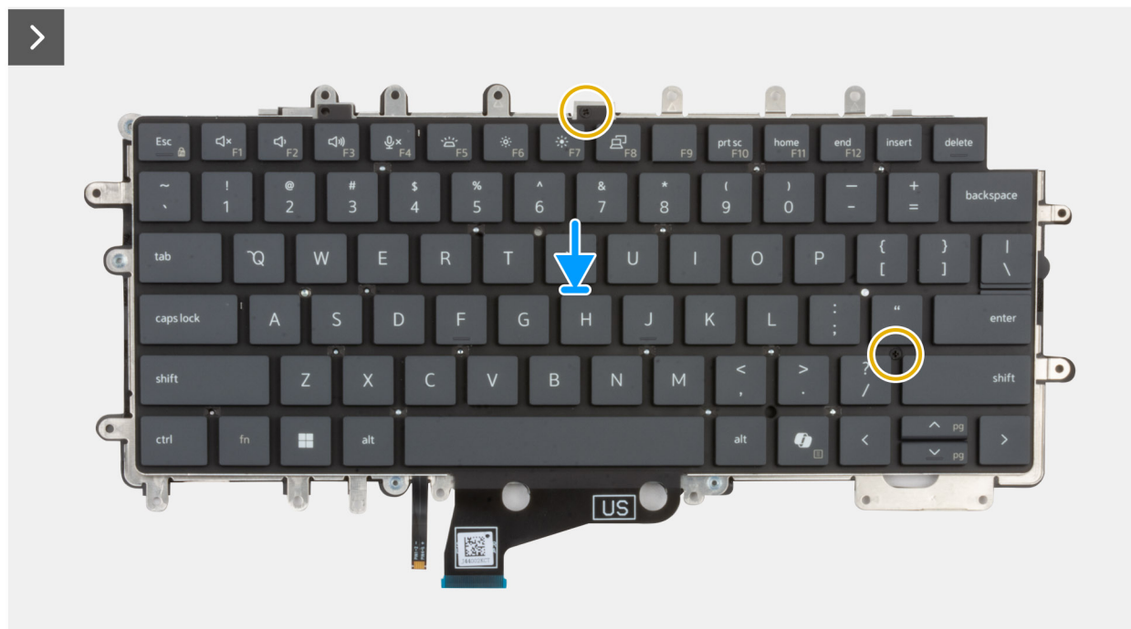
Afbeelding 68. Het toetsenbord installeren
