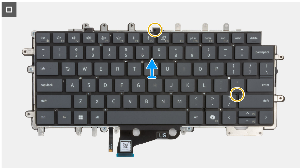
Afbeelding 67. Het toetsenbord verwijderen
