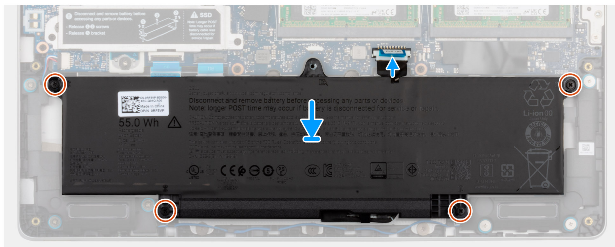
Afbeelding 24. De batterij installeren
