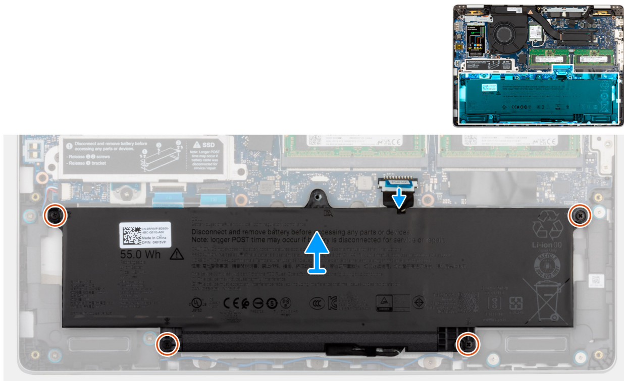
Afbeelding 19. De batterijkabel loskoppelen
