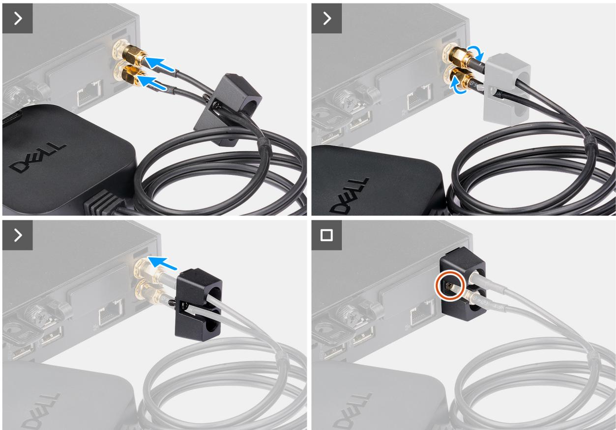
Abbildung 35. Einbauen der externen Puck-Antenne
