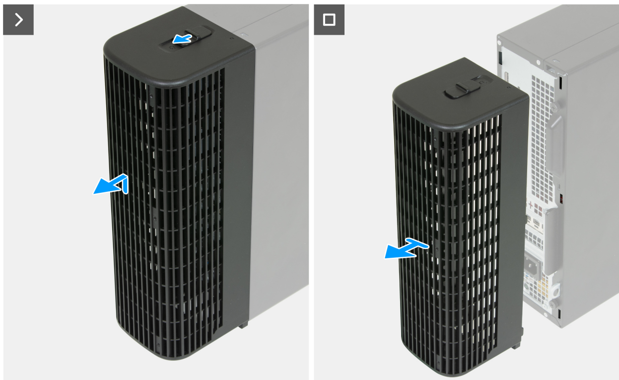
Afbeelding 4. De kabelkap verwijderen
