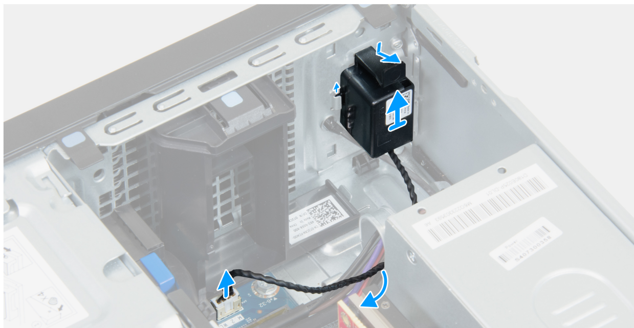
Afbeelding 18. De interne luidspreker verwijderen
