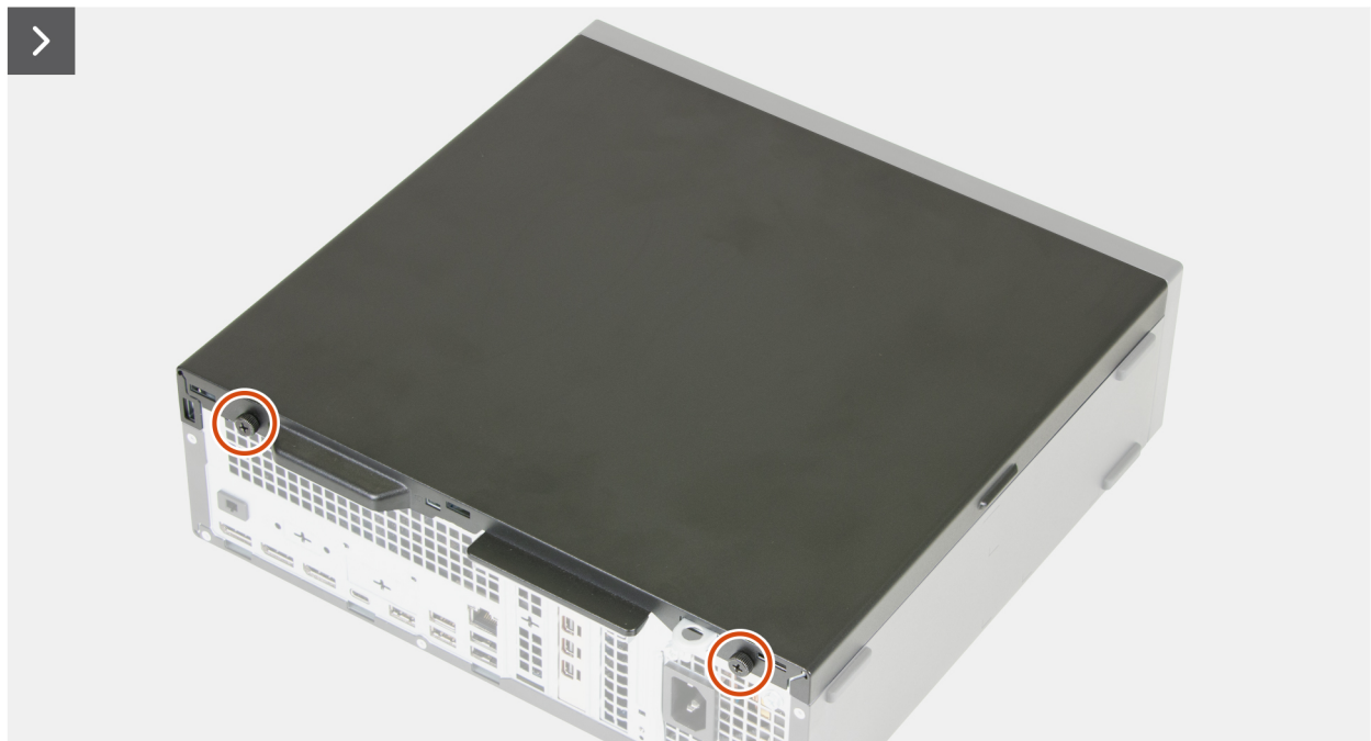
Afbeelding 6. De zijplaat verwijderen
