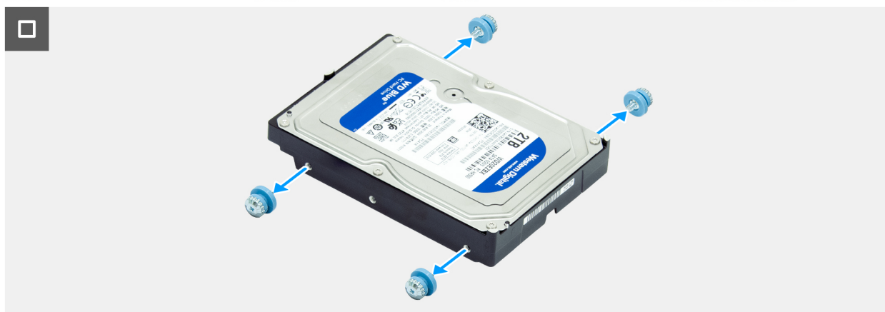
Afbeelding 39. De harde schijf verwijderen
