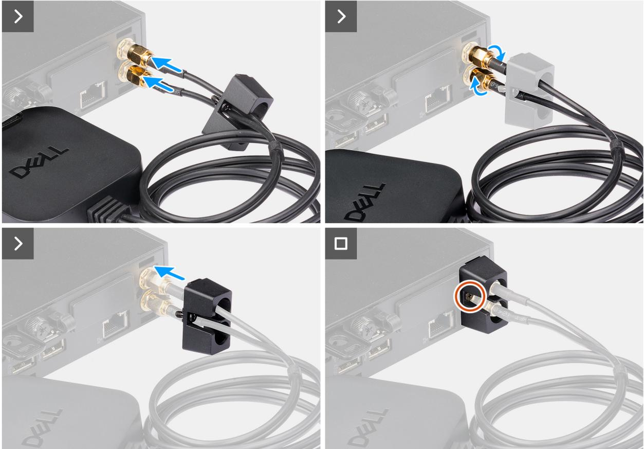
Figure 35. Installation de l'antenne Puck externe
