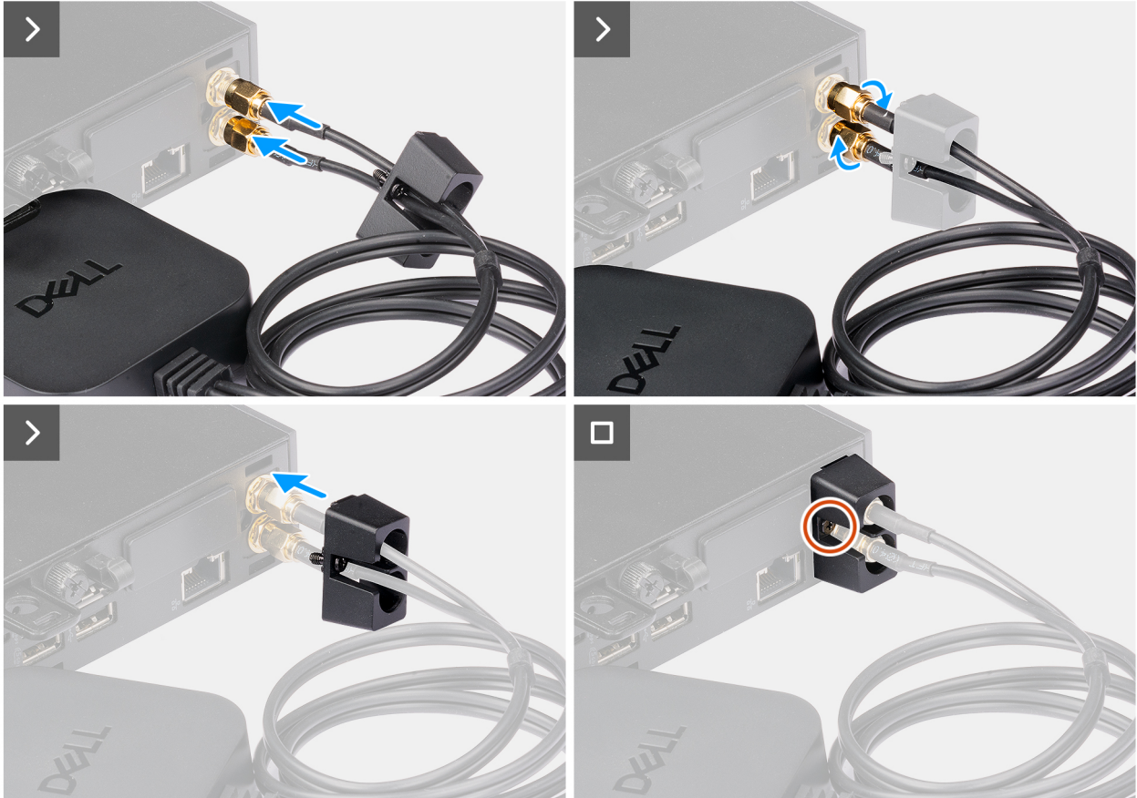
Figure 35. Installation de l'antenne Puck externe
