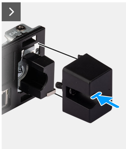
Figure 74. Installation du module d'antenne (câble blanc)
