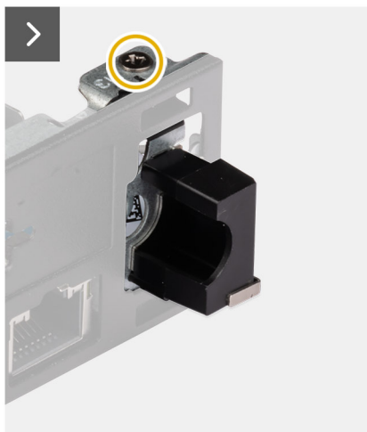
Figure 74. Installation du module d'antenne (câble blanc)
