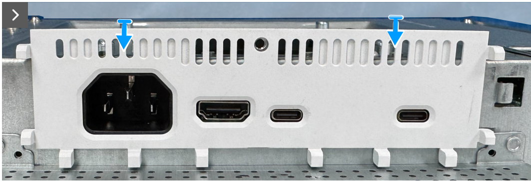
Figura 28. Retirar la cubierta de E/S de la protección metálica
