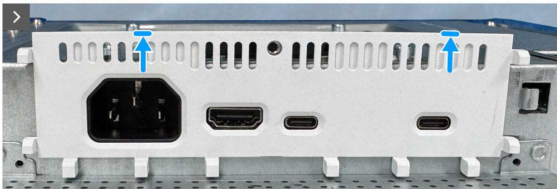
Figura 33. Volver a colocar la cubierta de E/S de la protección metálica
