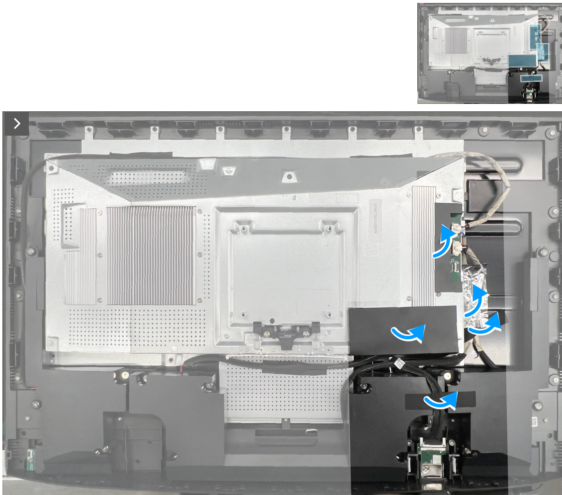
Figura 19. Despegar las cintas para fijar los cables y la cinta Mylar
