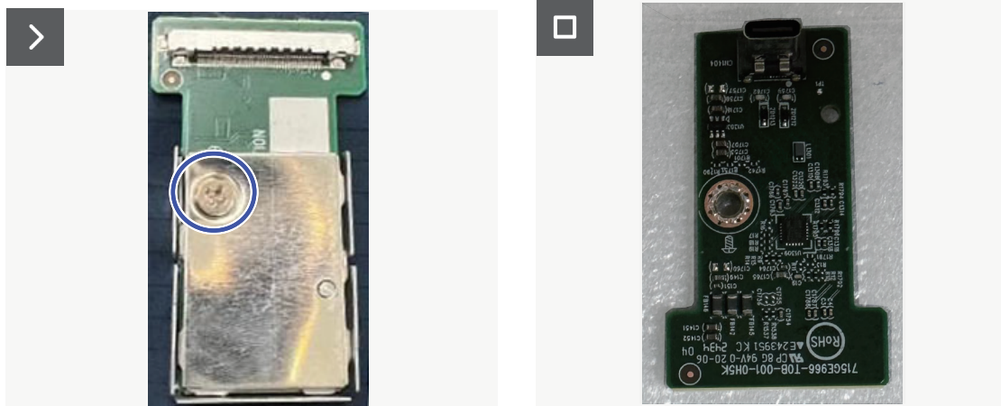
Figura 39. Retirar la placa USB
