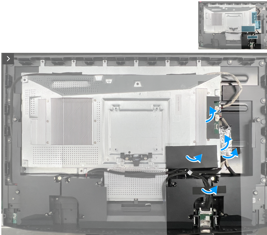
Figura 7. Despegar las cintas para fijar los cables y la cinta Mylar
