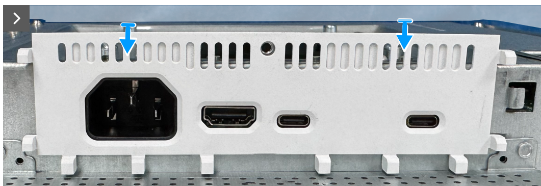
Figura 16. Retirar la cubierta de E/S de la protección metálica
