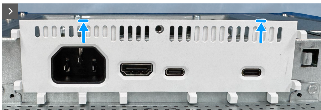
Figura 21. Volver a colocar la cubierta de E/S de la protección metálica
