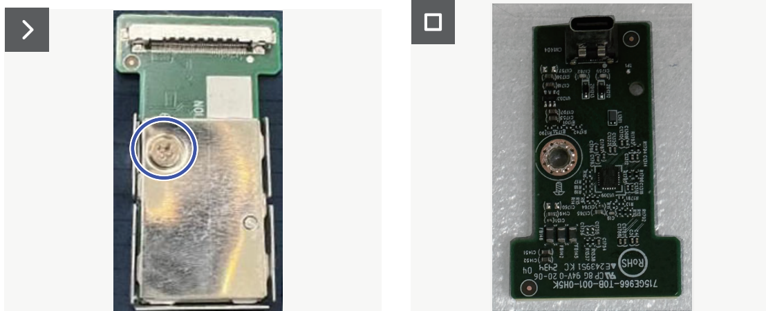
Figura 27. Retirar la placa USB
