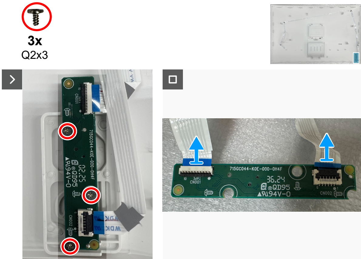
Figura 29. Retirar la placa del teclado y desconectar los cables
