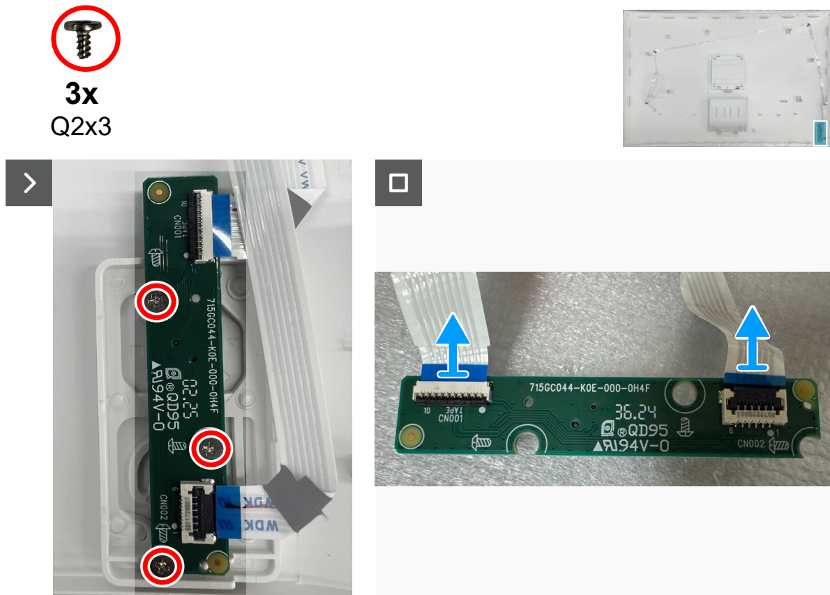
Figure 41. Enlever la carte du pavé et débrancher les câbles
