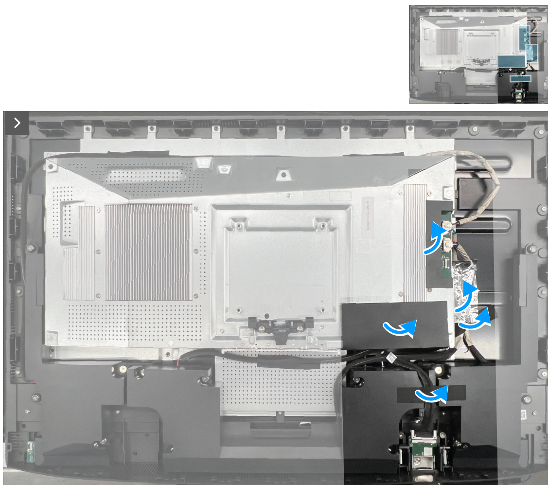
Figure 19. Décoller les rubans pour fixer les câbles et le Mylar
