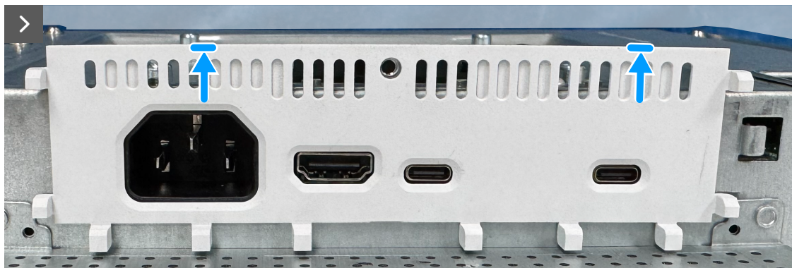
Figure 33. Remettre le couvercle des E/S du blindage métallique
