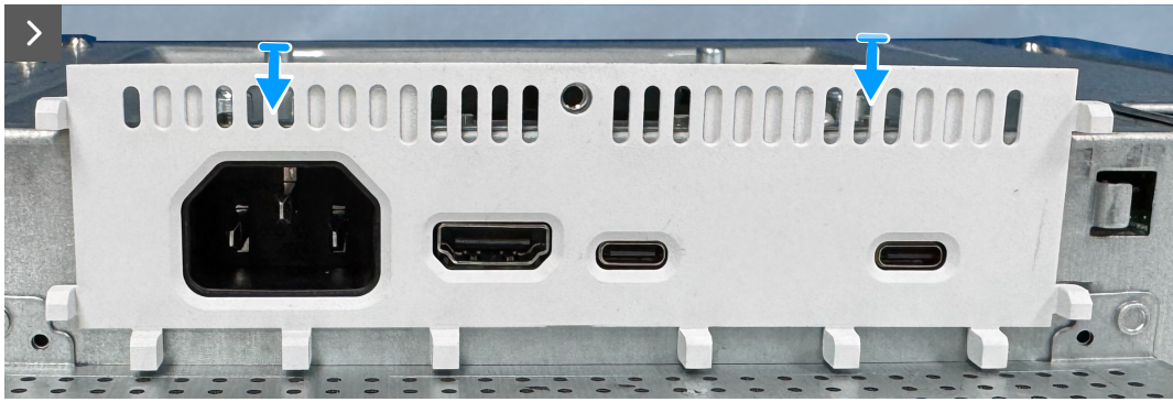
Figure 28. Enlever le couvercle des E/S du blindage métallique
