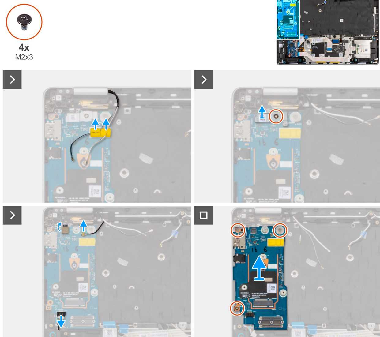
Obrázek 60. Removing the I/O board
