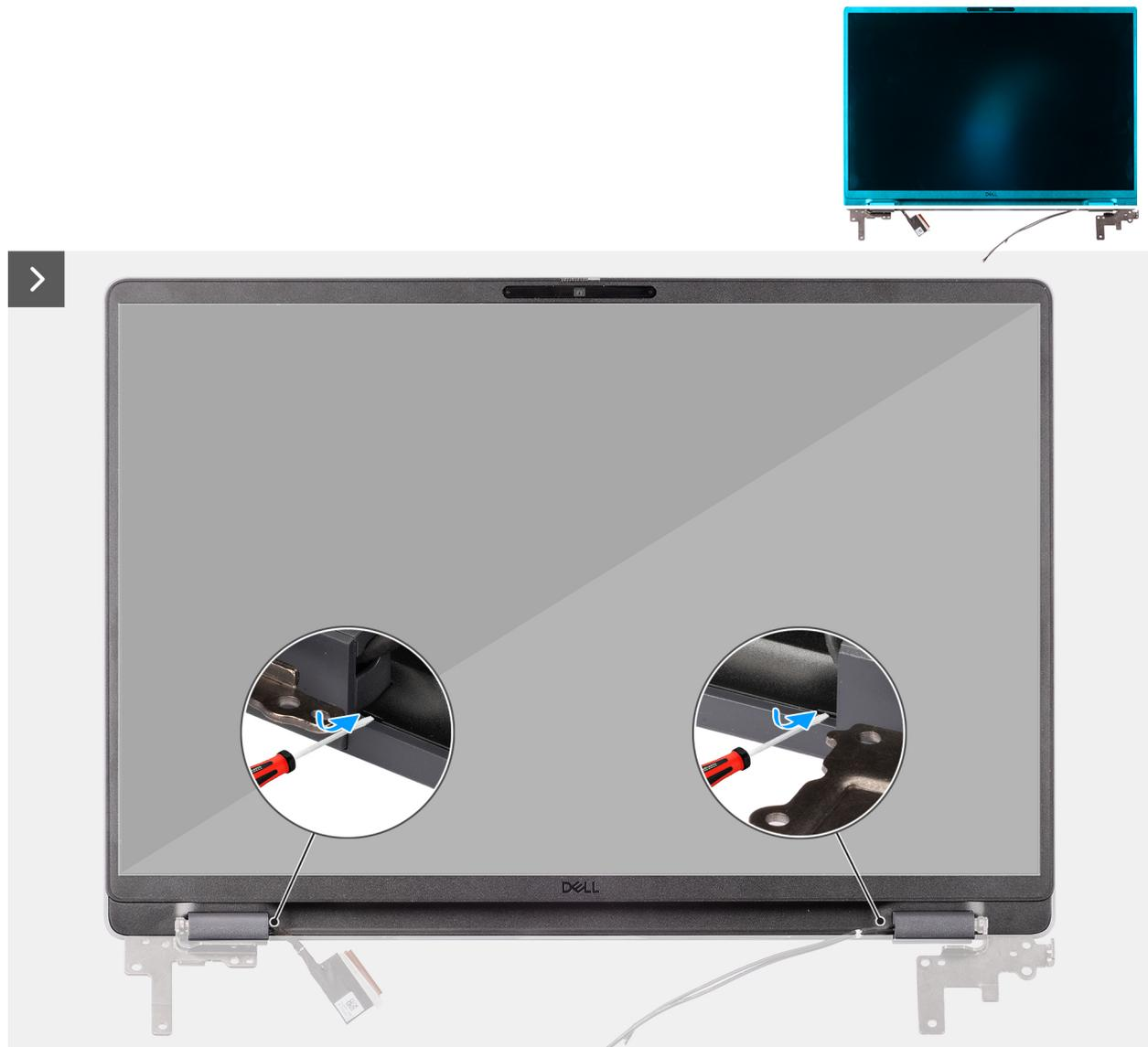
Abbildung 77. Removing the display bezel
