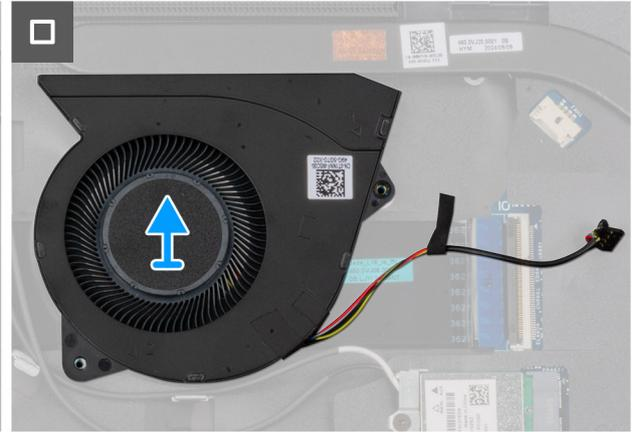
Abbildung 30. Removing the fan
