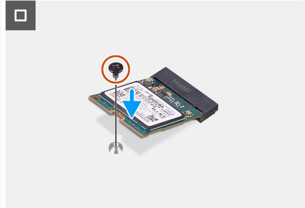
Abbildung 24. Installing the SSD
