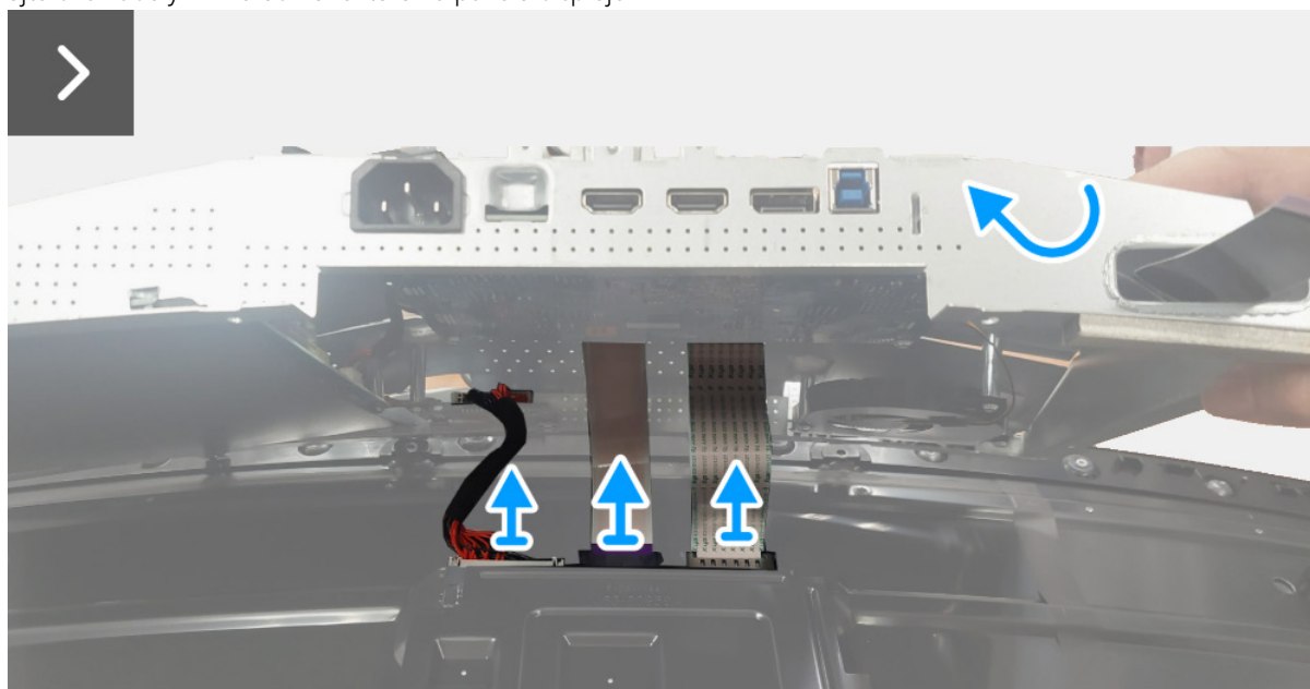
Obrázek 12. Demontáž kovového štítu
