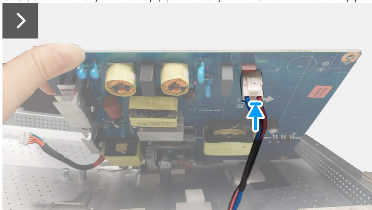
Obrázek 42. Instalace napájecí desky
