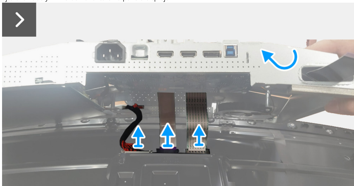
Obrázek 21. Demontáž kovového štítu
