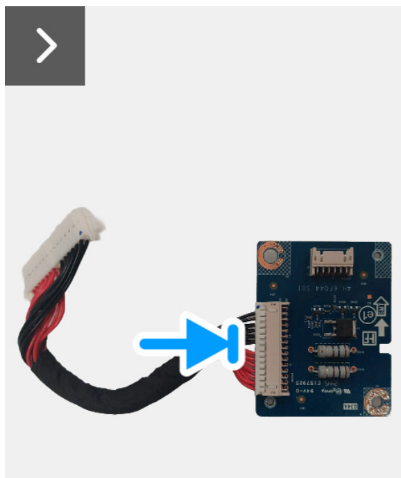
Obrázek 36. Instalace desky DC-DC
