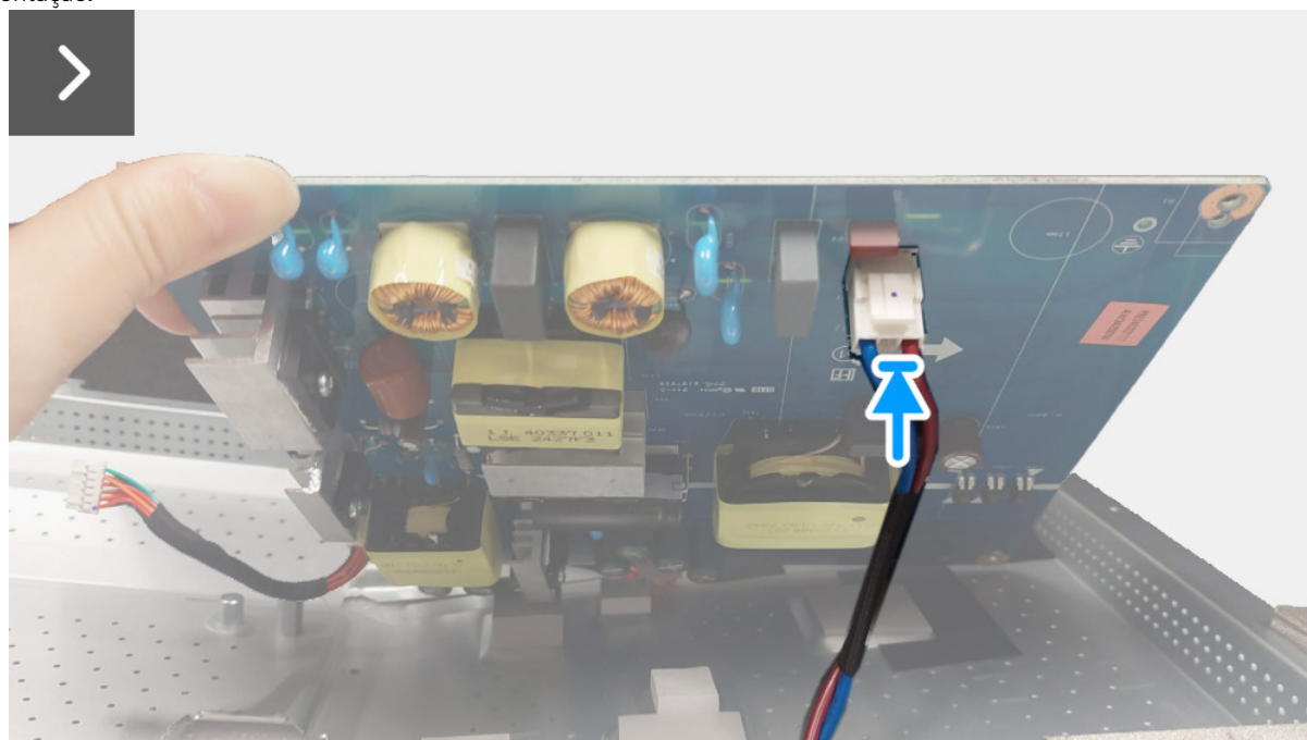
Figura 33. Instalar a placa de alimentação
