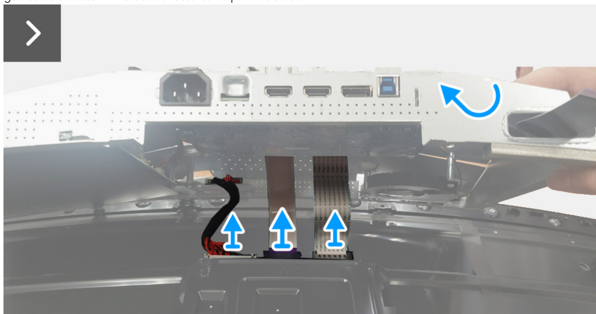
Figura 12. Remover a proteção metálica
