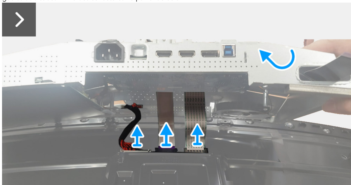
Figura 21. Remover a proteção metálica
