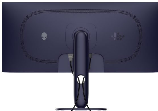
Figura 22. Organización de los cables
