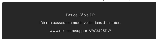
Figure 82. Message d'avertissement en cas d'absence de câble de signal
