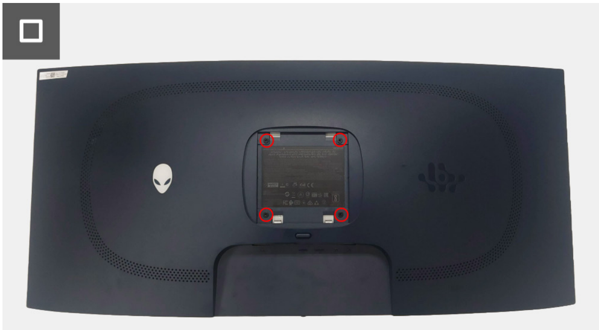
Immagine 9. Installazione del coperchio posteriore
