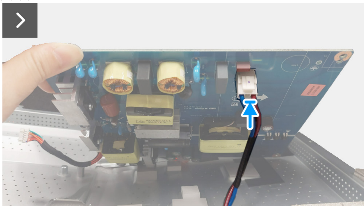
Immagine 33. Installazione della scheda alimentazione
